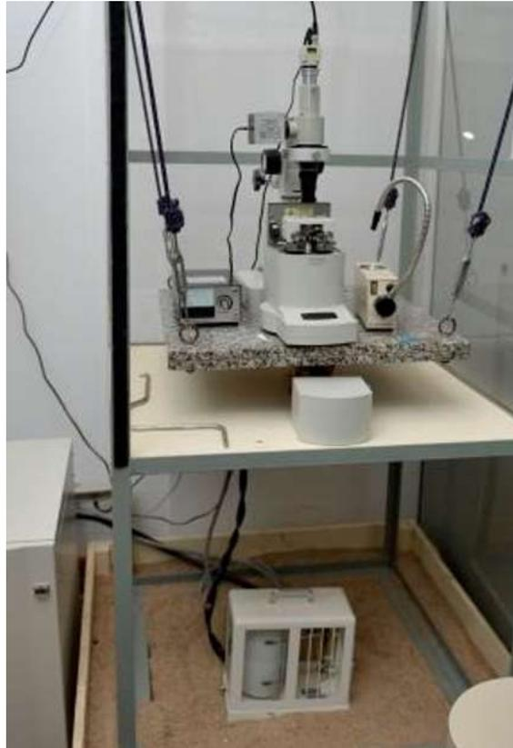
**Figura 41** – Microscópio de força atômica *Shimadzu SPM 9500*.
