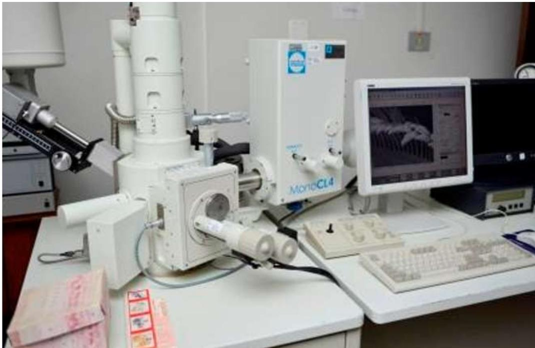
**Figura 40** – Microscópio eletrônico de varredura *Jeol* JSM 6360LV.
