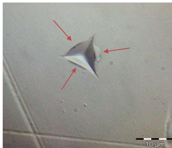
**Figura 39** – Impressão residual da Amostra #1 de sílica com ampliação de 2500 vezes por microscopia óptica auxiliada pelo programa *analySIS* 5.1.
