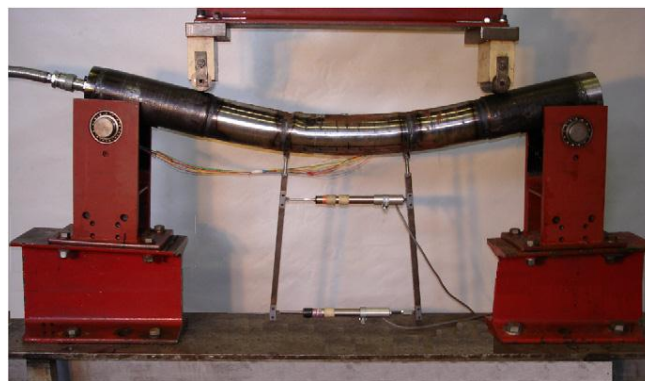
Figura 10 – Dobramento de duto em laboratório (Iflefel et al., 2005)
