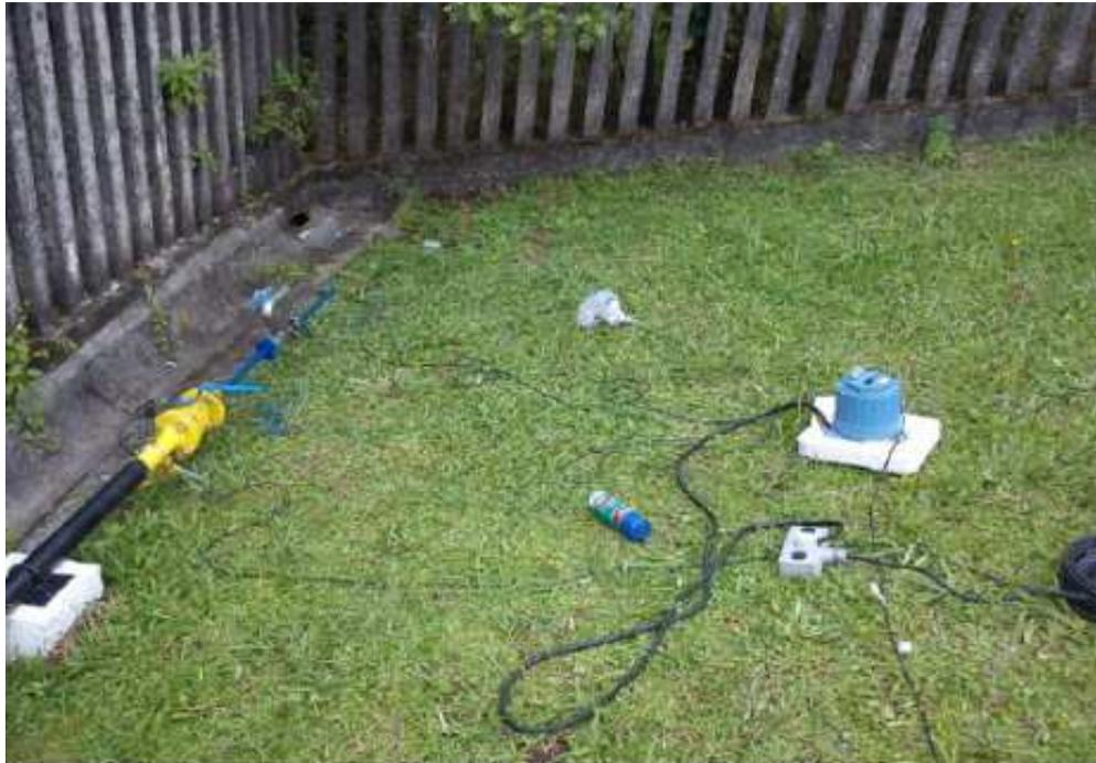
Figura 6.11 – Detalhe da instalação do medidor de vazão tipo *Coriollis* para realização dos testes com ar comprimido.
