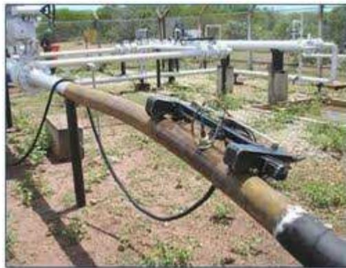
Figura 2.12 – Inspeção por ultrassom automatizado, ([www.pasa.com.br](http://www.pasa.com.br)).
