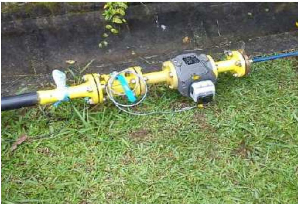
Figura 6.14 - Detalhe da instalação do medidor de vazão tipo rotativo para realização dos testes com gás natural.
