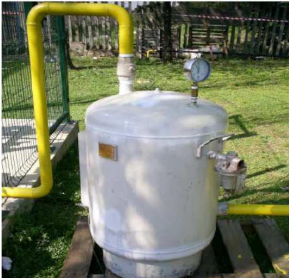
Figura 6.4 – Detalhe do vaso de pressão (tanque de acumulação) utilizado nos testes realizados com ar comprimido.
