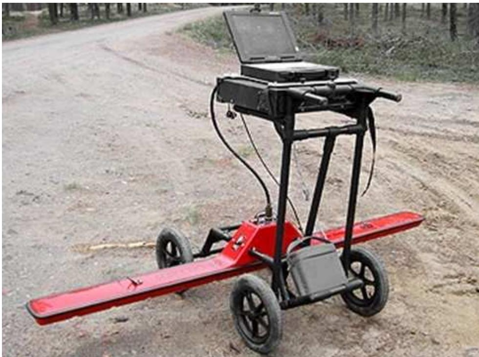
Figura 2.11 – Radar de penetração no solo – GPR,
