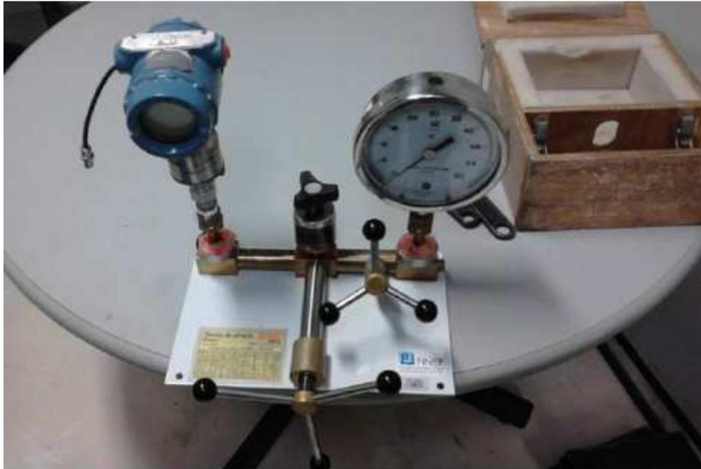
Figura 6.15 - Detalhe do dispositivo utilizado para aferição dos transdutores de pressão.
