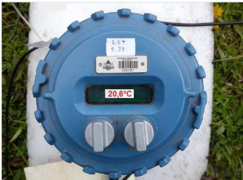
Figura 6.13 – Visor do medidor de vazão tipo *Coriollis*, identificando uma temperatura correspondente de 20,6°C.
