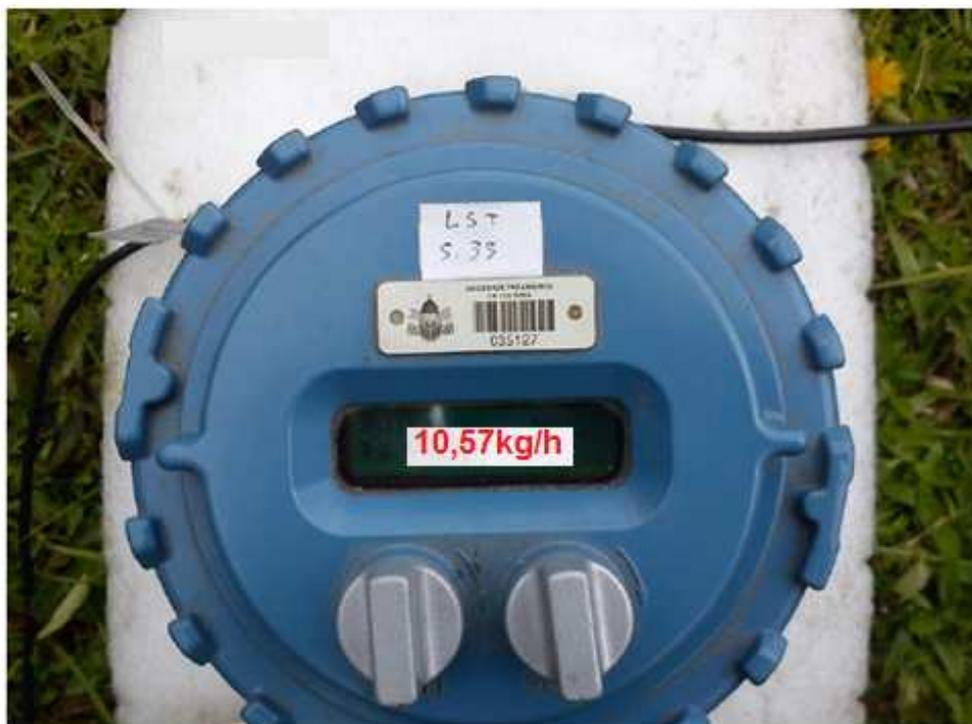
Figura 6.12 – Visor do medidor de vazão tipo *Coriollis*, identificando uma vazão mássica correspondente de 10,57 kg/h.
