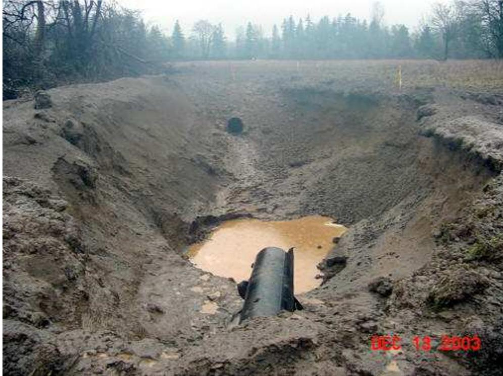
Figura 1.1 – Trecho de tubulação de gás natural rompida devido à falha localizada seguido de explosão, ([www.events.nace.org](http://www.events.nace.org)).
