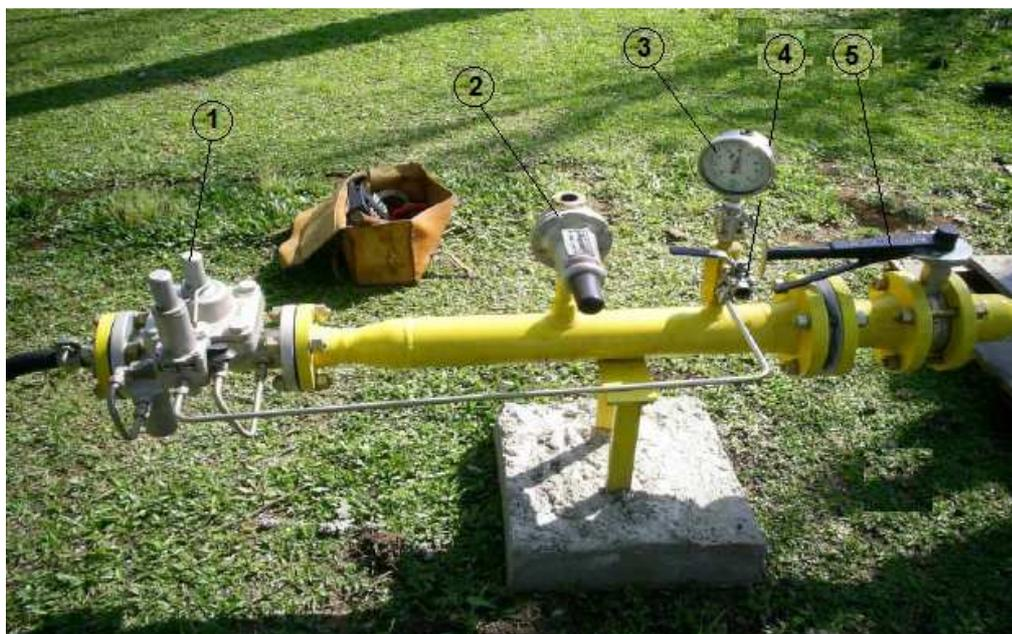
Figura 6.6 – Detalhe do sistema de redução e regulação de pressão utilizado nos testes com ar comprimido
