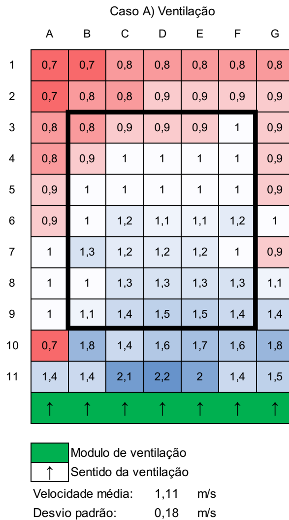
Figura 65 – Caso A: Campo da ventilação
