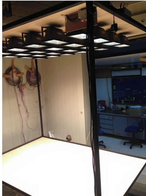
Figura 44 – Simulador Solar instalado na câmara climatizada do LST da PUCPR.
