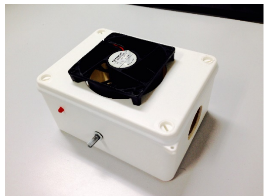
Figura 63 – Controle PWM do sistema de ventilação no Simulador Solar
