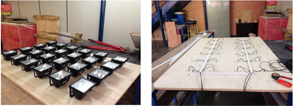
Figura 42 – Simulador Solar: arranjo com 24 refletores dispostos em forma de matriz 4x6.
