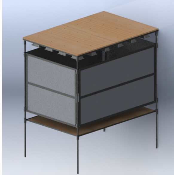
Figura 52 – Caso B: simulador Solar com o material reflexivo nas laterais
