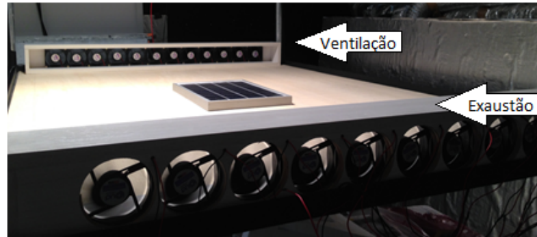
Figura 66 – Caso B: sistema de ventilação e exaustão do Simulador Solar
