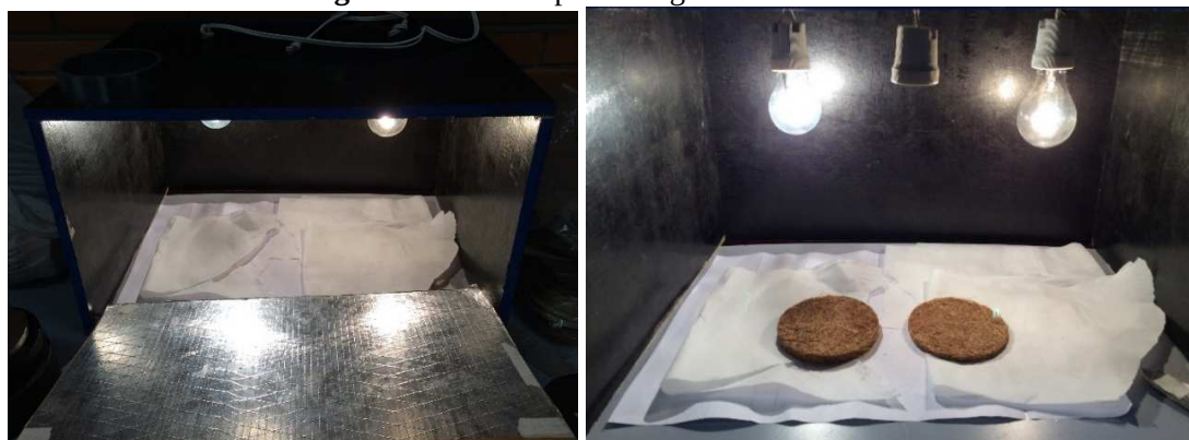
Figura 28 – Estufa para secagem das amostras
