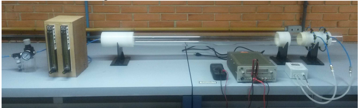
Figura 42 - Bancada de resistividade ao fluxo.
