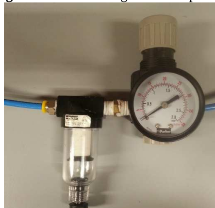
Figura 43 - Válvula reguladora de pressão
