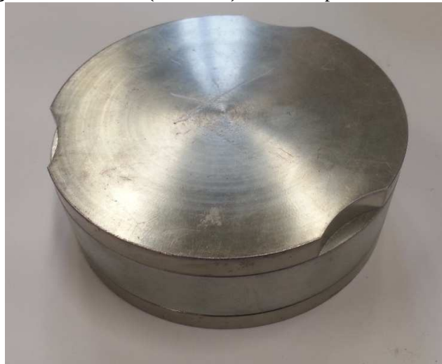
Figura 26 – Mistura (cola/coco) inserida e prensada no molde
