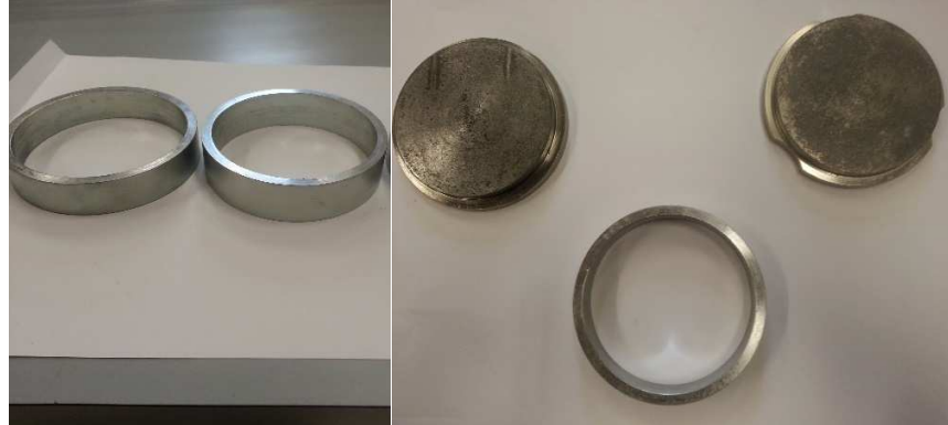
Figura 24 – Anéis para amostras de 5 e 10 mm de espessura respectivamente e tampas.
