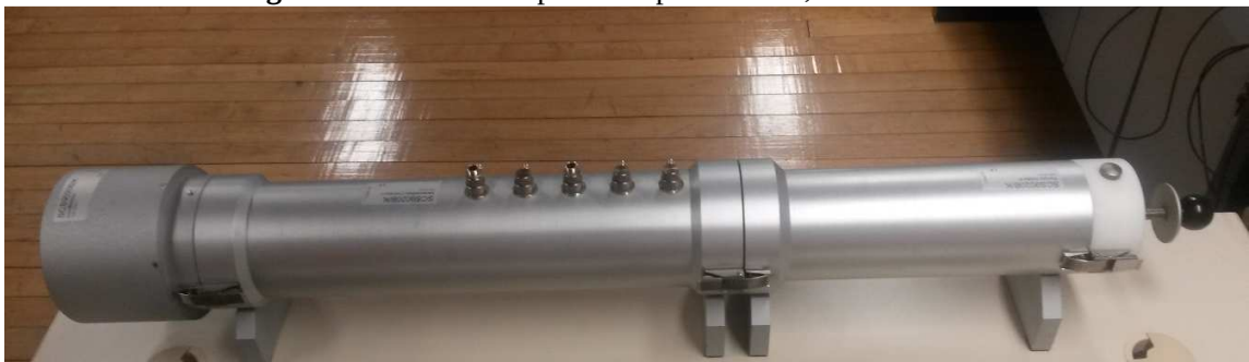
Figura 35 - Tubo de impedância para o MFT, MDCM e MDE
