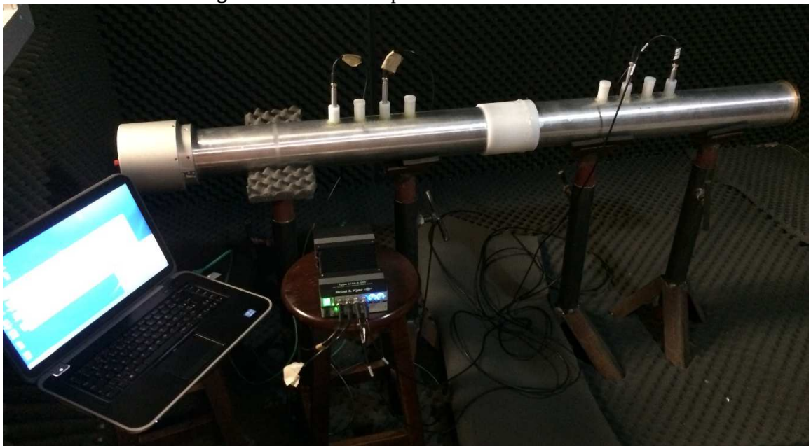
Figura 37 - Tubo de impedância com 4 microfones
