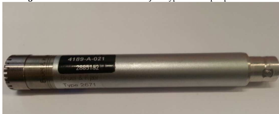
Figura 40 - Microfone ½'' Brüel & Kjær Type 4189-A pré-polarizados
