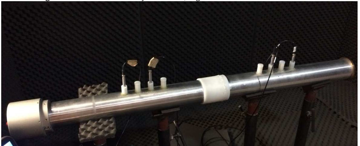
Figura 34 - Bancada de medição montada, segundo a norma ASTM E2611-09.
