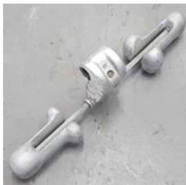
Figura 47 - Stockbridge assimétrico utilizado nos ensaios de vibração. Fonte: O Autor.
