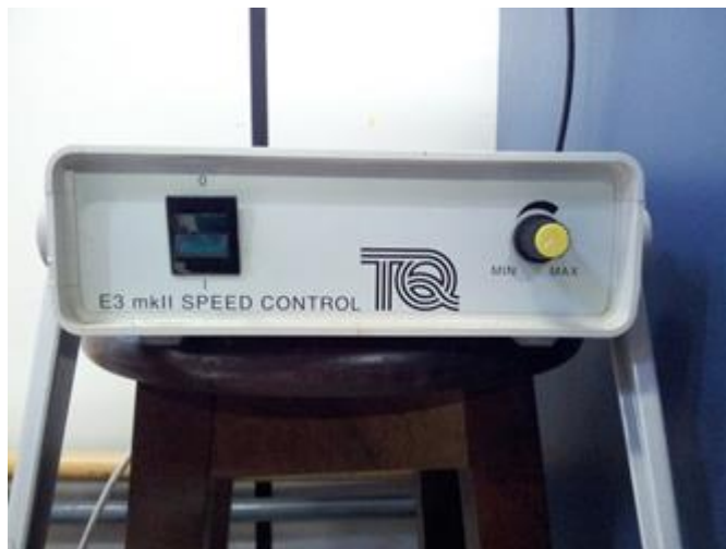
Figura 71 - Controlador de velocidade E3 mkII da TecQuiment. Fonte: Marchi e Merino, 2014.
