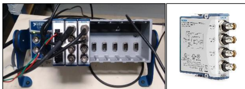
Figura 4 – cDAQ 9188 com destaque do módulo NI 9234 à direita Fonte: O autor.
