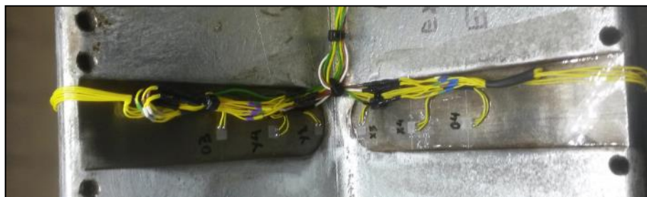
Figura 69 - Instrumentação dos montantes Fonte: Engemovi.
