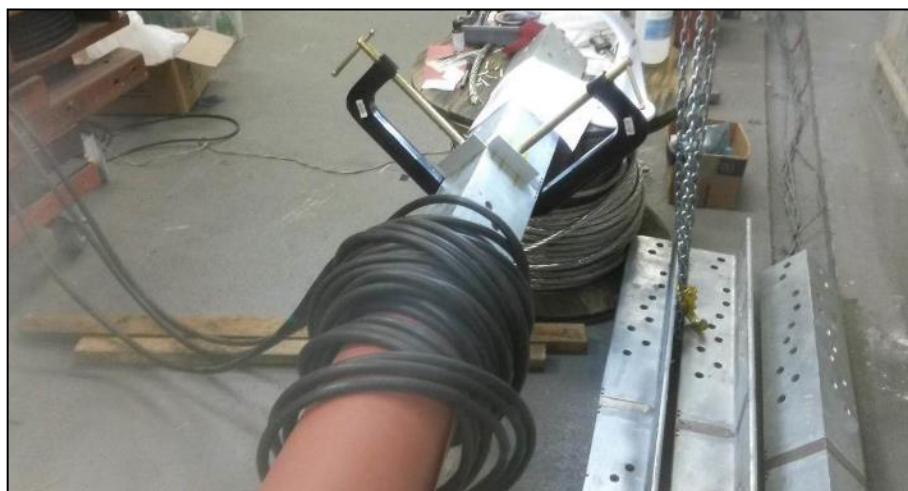
Figura 67 - Colagem dos extensômetros no montante Fonte: Engemovi.
