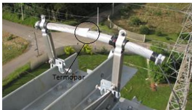
Figura 2 - Termopar inserido na amostra de condutor Fonte: O autor.
