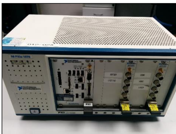
Figura 3 – Chassis PXI com os módulos utilizados Fonte: O autor.
