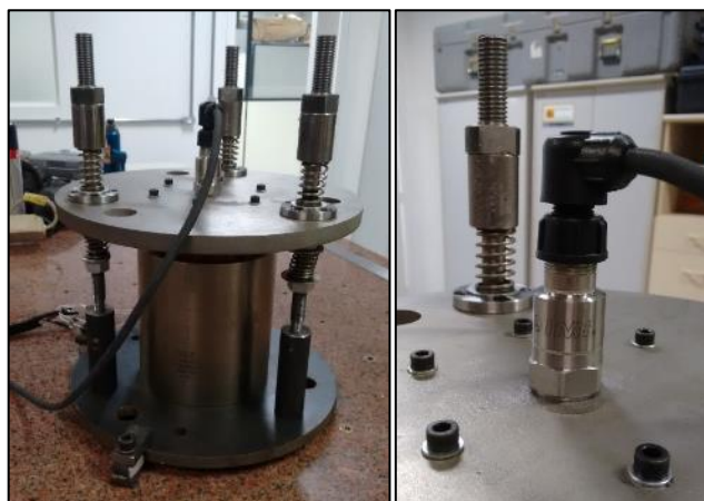
Figura 11 - Atuador eletrodinâmico preso a mesa de testes. À direita detalhe do acelerômetro instalado na mesa de vibração Fonte: Lactec.
