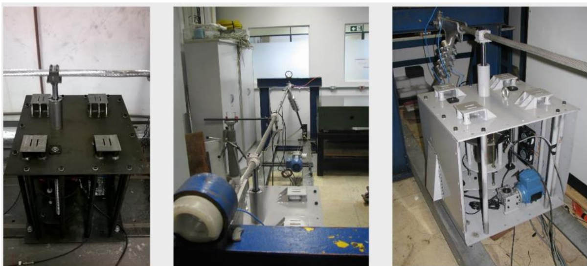
Figura 12 – Testes realizados em bancada com o vibrador contendo todos os seus componentes Fonte: O autor.
