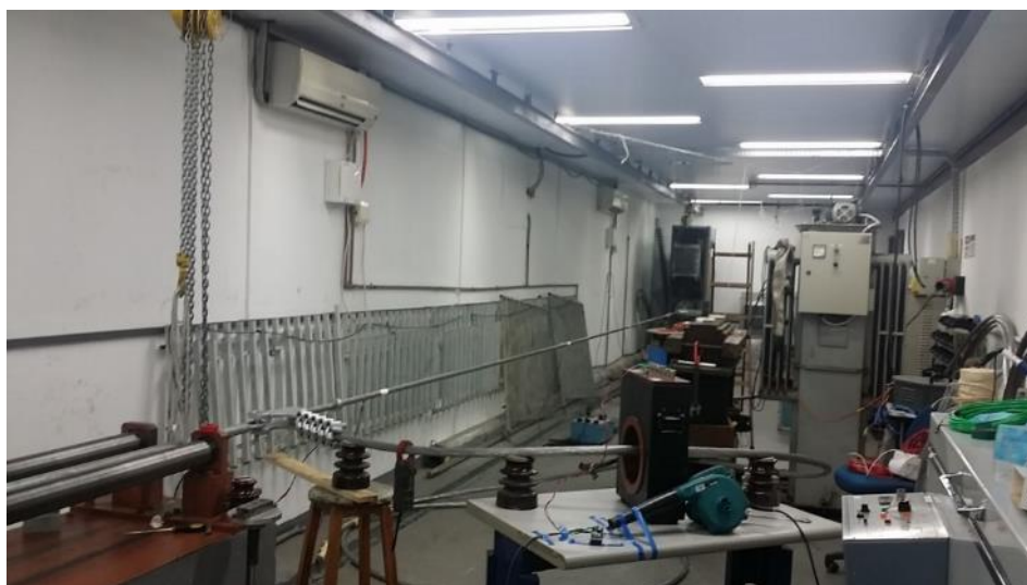
Figura 85. Disposição da montagem do ensaio para medições da resistência elétrica em CA e CC Fonte: O autor.
