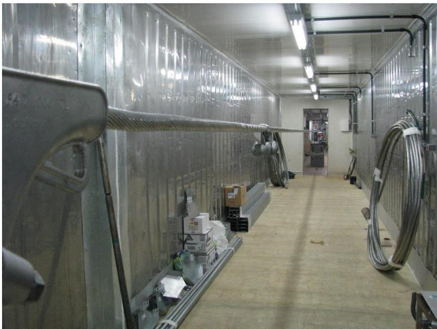
**Figura 1: Bancada de ensaios de cabos condutores com Stockbridge acoplado**
