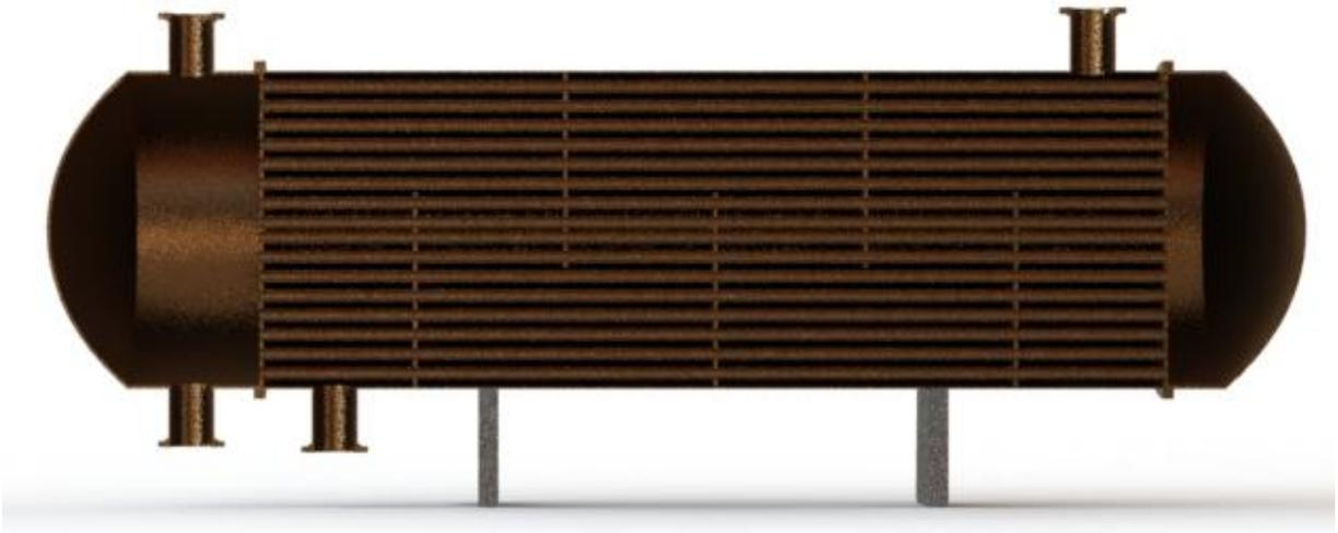
Figura B.3 – Representação ilustrativa da geometria do trocador de calor casco tubo.
