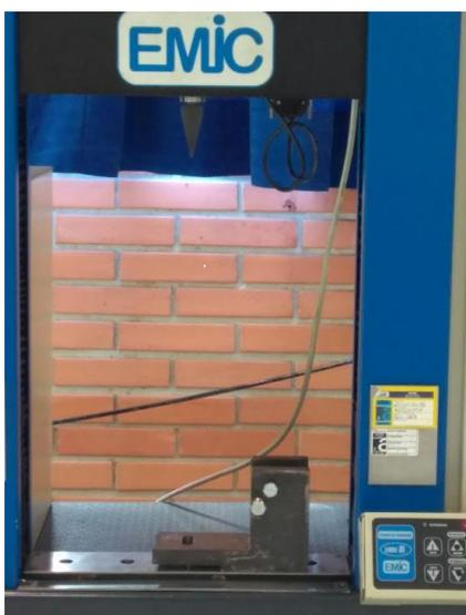
Figura 2.3 Máquina de ensaio universal do modelo EMIC DL500.
