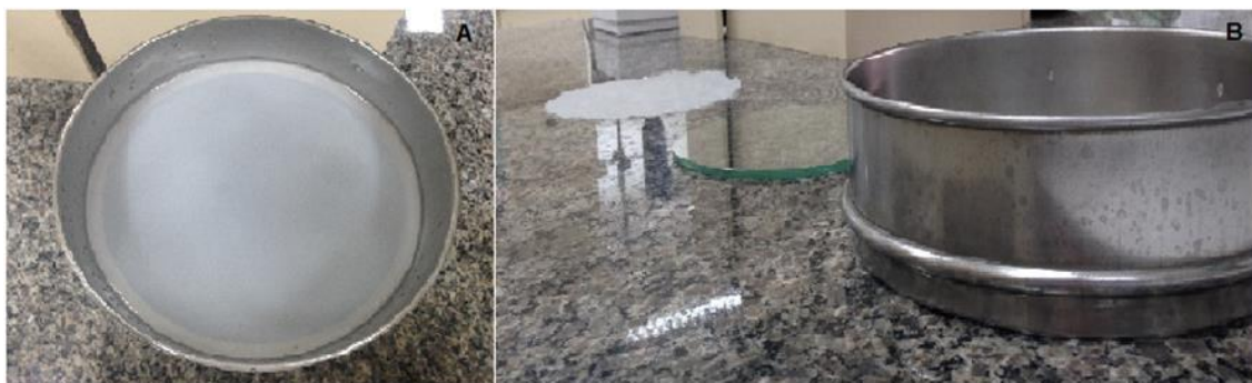
Figura 2.2. Imagem fotográfica da filtração da suspensão de nanocelulose (a) e do sistema de filtração (B).
