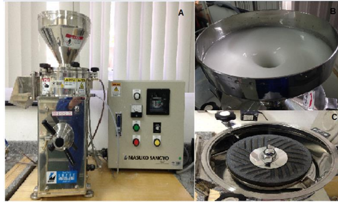
Figura 2.1. Imagem fotográfica do moinho Masscolloider Masuko Sangyo (A), em funcionamento (B), e do disco de pedra rotativo necessário para o preparo de celulose nanofibrilada.
