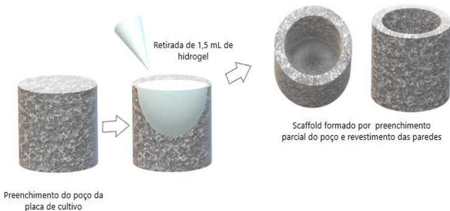
Figura 3. Esquema representativo da fabricação dos arcabouços do L2F.
