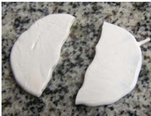
Figura 1. Pastilha cristalizada do vitrocerâmico.
