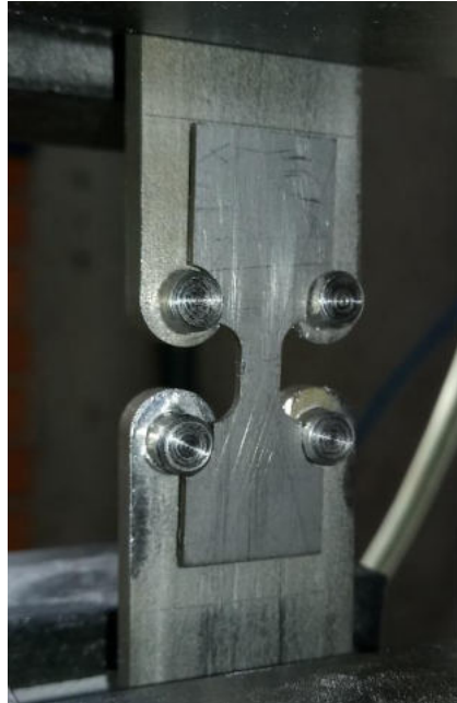
Fig. 4-33. Detalhe da simulação de posicionamento do CdP no Suporte. (Fonte: o Autor)
