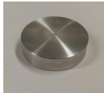
Fig. 5-20. Acessórios do nanoindentador: a) base para ensaio dos CdP; b) porta amostra fabricada para ser encaixada na base de ensaio. (Fonte: o autor)
