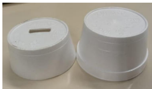
Fig. 4-32. Nova Câmara para ETr. Em a) imagem da Câmara como fornecida. Em b) Câmara com o corte inferior para fixação do Suporte com Vedação e redução de altura. (Fonte: o Autor)
