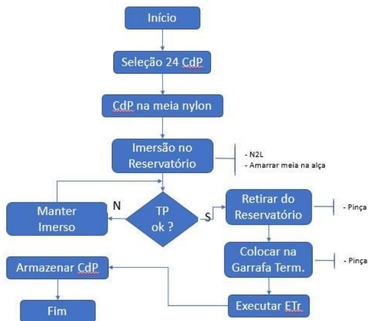
Fig. 4-13. Fluxograma com o procedimento para ETr dos CdP. (Fonte: o autor)
