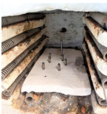
Fig. 4-15. Recozimento dos tarugos: a) peças dentro do forno Mufla; b) a rampa de aquecimento utilizada para o recozimento dos CdP. (fonte: o autor)
