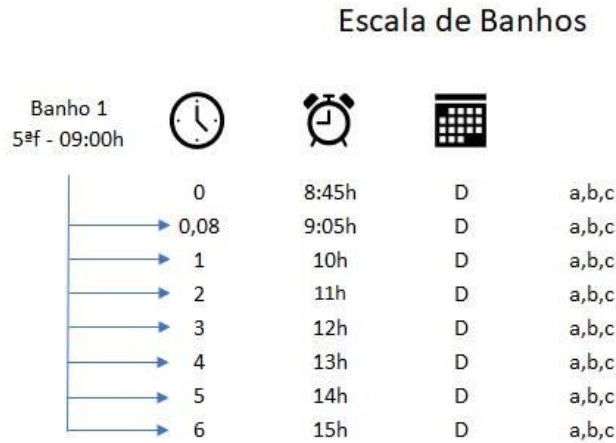
Fig. 3-28. Escala dos banhos para o ensaio, com a numeração dos CdP para cada tempo no ETr. A coluna de tempo representada em horas com variação de TP até 6 h e D representa o dia da imersão. Este planejamento foi válido para Ti6Al4V e Ti CP. (Fonte: o autor)
