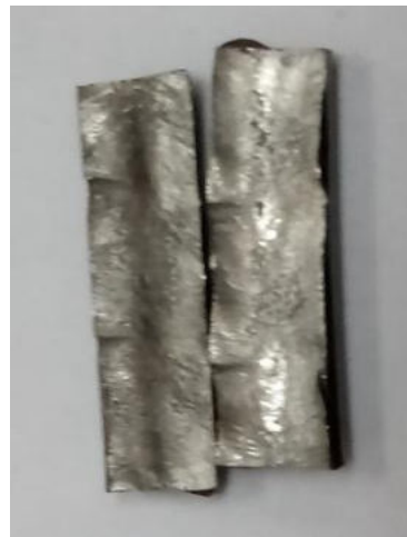
Fig. 3-01. CdP pós laminação: a) vista externa CdP recém laminado e b) vista interna do CdP. (Fonte: o autor)
