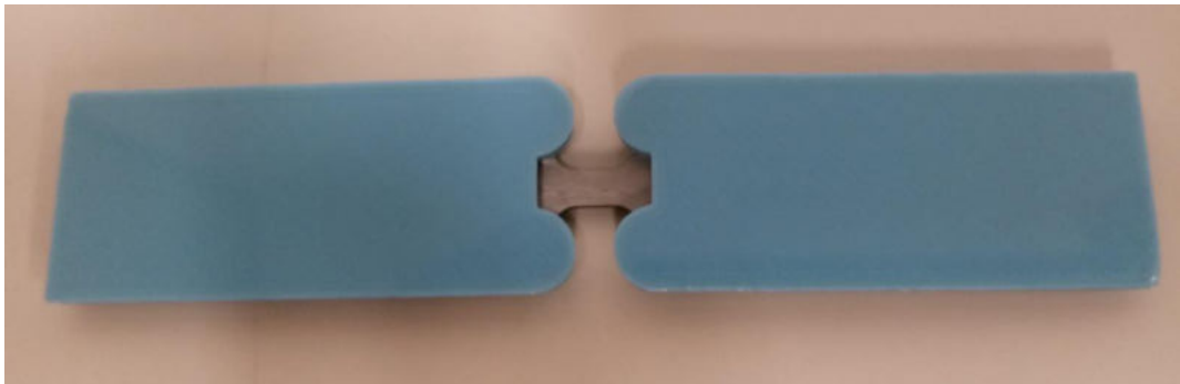
Fig. 4-23. Montagem do protótipo dos suportes em PLA com o CdP posicionado: a) vista frontal; b) vista traseira. (Fonte: o autor)
