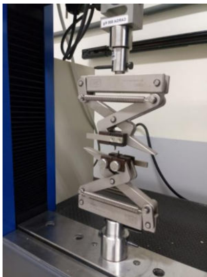
Fig. 5-01. Acessório de alavanca instalado no equipamento DL2000: a) se observa a disposição do acessório; b) detalhe da célula de carga com capacidade de 500 kgf onde o acessório é acoplado pelo pino. (Fonte: o autor)
