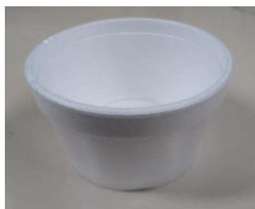
Fig. 4-32. Nova Câmara para ETr. Em a) imagem da Câmara como fornecida. Em b) Câmara com o corte inferior para fixação do Suporte com Vedação e redução de altura. (Fonte: o Autor)
