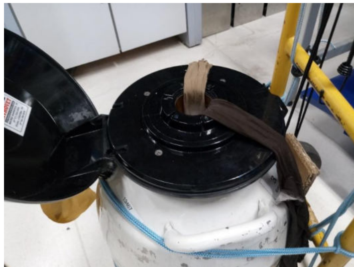
Fig. 3-29. Reservatório de N 2 L com duas meias de nylon colocadas pelo bocal. Uma das meias contém Ti6Al4V ELI e a outra Ti CP, cada uma identificada por etiquetas. (Fonte: o autor)
