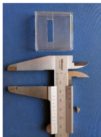
Fig. 4-28. Câmara Reservatório de N2L: a) a caixa plástica; b) janela no fundo da caixa para a passagem do conjunto e fixação da antepara. (Fonte: o autor)
