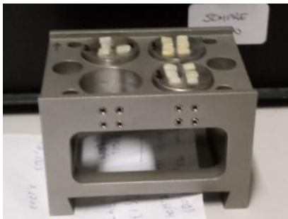
Fig. 5-20. Acessórios do nanoindentador: a) base para ensaio dos CdP; b) porta amostra fabricada para ser encaixada na base de ensaio. (Fonte: o autor)
