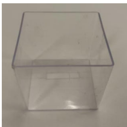
Fig. 4-28. Câmara Reservatório de N2L: a) a caixa plástica; b) janela no fundo da caixa para a passagem do conjunto e fixação da antepara. (Fonte: o autor)
