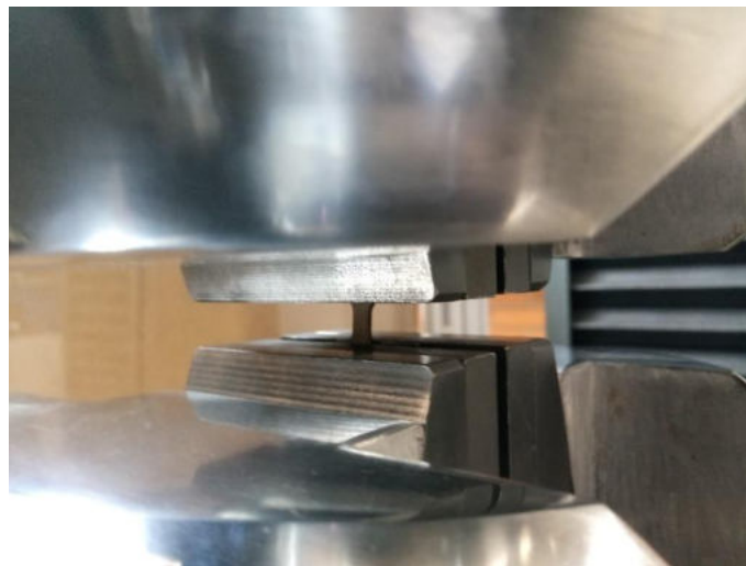
Fig. 4-19. Equipamento de tração MTS Exceed E45: a) vista do módulo de ensaio; b) detalhe do cabeçote de ensaio com as garras; c) imagem com grande aproximação do CdP preso nas garras do cabeçote de ensaio. (Fonte: o autor)
