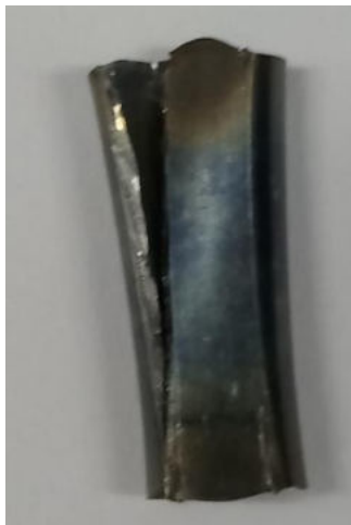
Fig. 3-01. CdP pós laminação: a) vista externa CdP recém laminado e b) vista interna do CdP. (Fonte: o autor)
