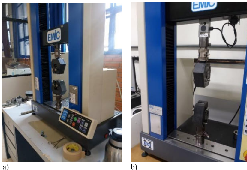
Fig, 4-20. Equipamentos de tração marca EMIC utilizados: a) modelo DL 500 e b) modelo DL 2000. (Fonte: o autor)
