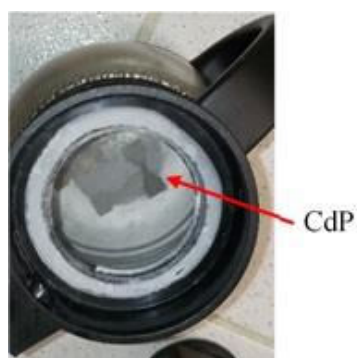
Fig. 4-12. Imagens do armazenamento: a) reservatório de 50 L para manutenção do nitrogênio no estado líquido; b) meia de nylon durante imersão no reservatório; c) garrafa térmica em aço inox para transporte dos CdP; d) CdP no interior da garrafa térmica, imerso em N2L (Fonte: o autor)
