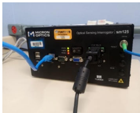
Fig. 4-34. Ilustração da FBG em sistema multiplexado para medições: a) esquema da FO com Rede de Bragg (FBG) e os demais instrumentos utilizados; b) painel do interrogador de 5pm utilizado neste experimento. (Fonte: o autor)
