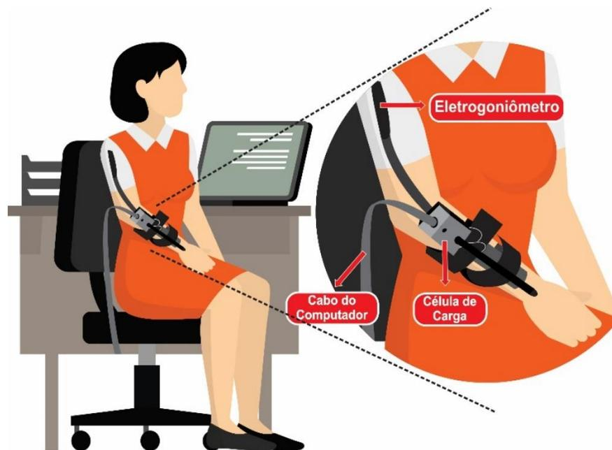
Figura 3 - Sistema desenvolvido com célula de carga no antebraço e eletrogoniômetro posicionado na articulação do cotovelo. Durante o teste, o avaliador realiza movimentos de extensão do cotovelo enquanto os dados são adquiridos e enviados para o computador. Adaptado de Pandyan et al. (2001).
