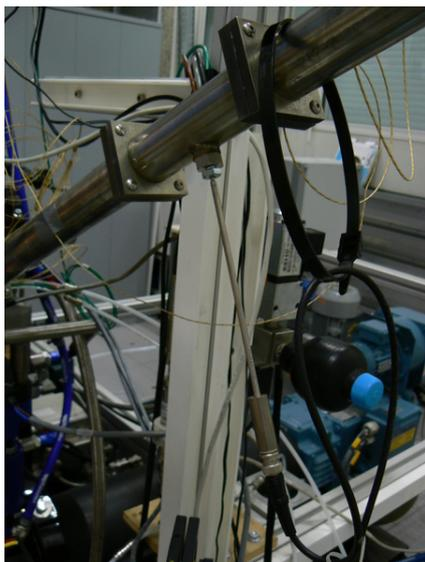
Figura 71: Instalação sensor de temperatura constituído por um fio de Platina-Ródio 10%, com diâmetro de  $1,2 \mu\text{m}$  e comprimento de 2 mm.
