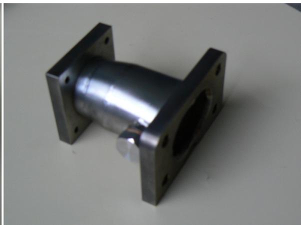
Figura 66: Peça de adaptação da exaustão (62 mm).
