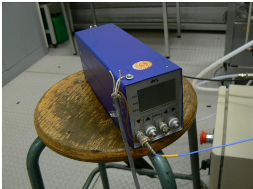
Figura 58: Ligação final do amplificador de carga.
