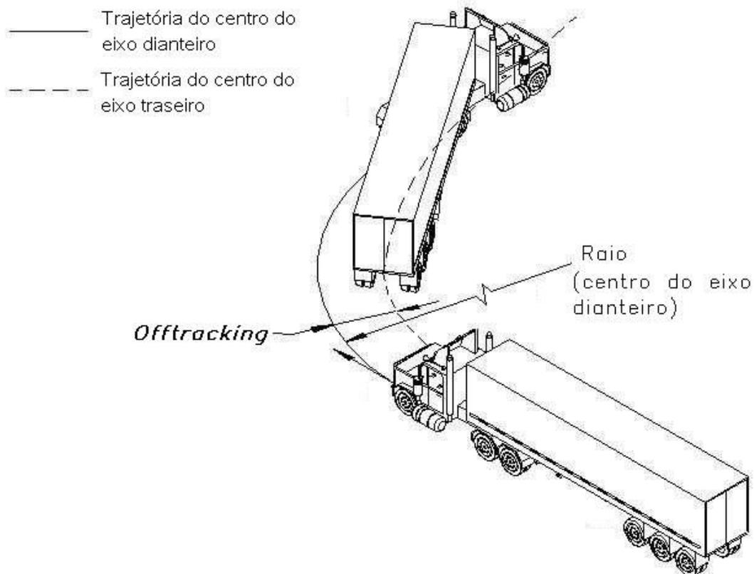
Outra medida importante para o projeto geométrico de rodovias, derivada do *offtracking*, é a chamada “Largura de Varredura” (*swept path width*) ou simplesmente “Varredura” como citado nos documentos técnicos do Brasil , conforme ilustrado na figura B.
