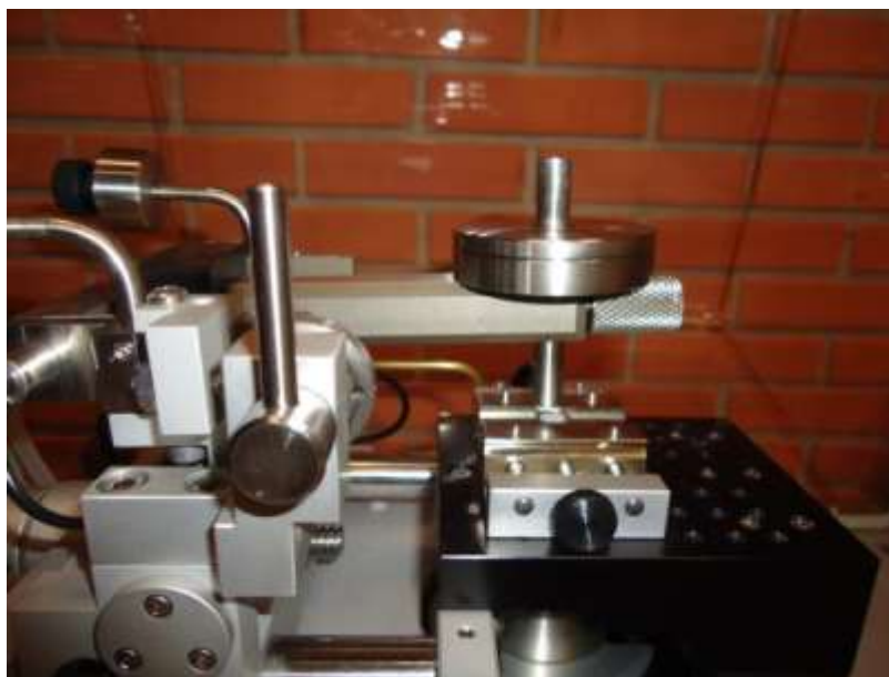
Figura 13 - Tribômetro CSM do Laboratório de Tribologia da PUCPR.
