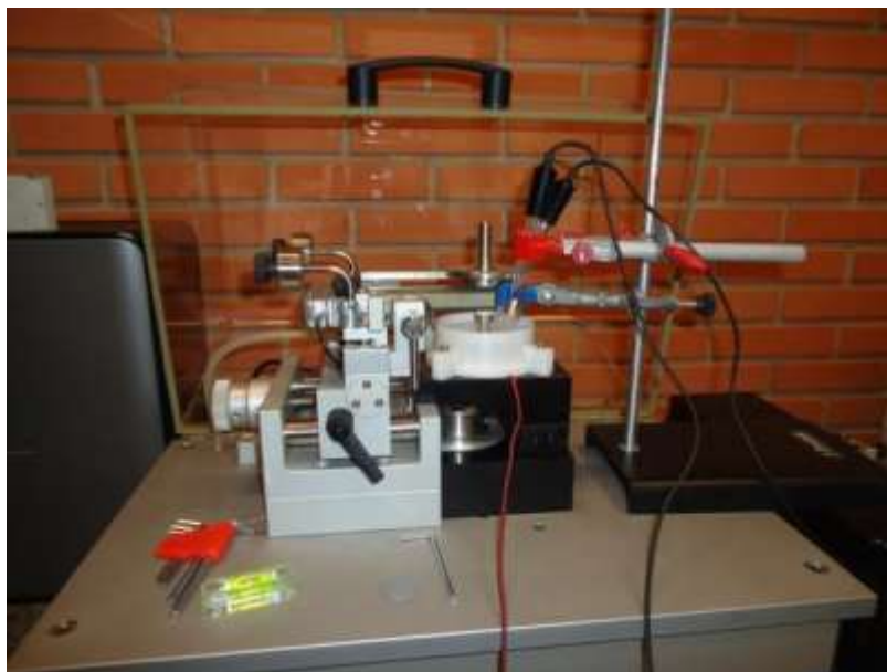
Figura 15 - Imagem indicando o conjunto para ensaio de tribocorrosão devidamente montado na plataforma do tribômetro.
