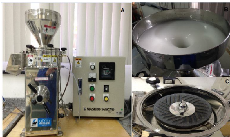
18 19 Figura 1. Imagem fotográfica do moinho Masscoloider Masuko Sangyo (A), em funcionamento (B), e 20 do disco de pedra rotativo necessário para o preparo de celulose nanofibrilada (C). Fonte: Claro, 21 2017.
