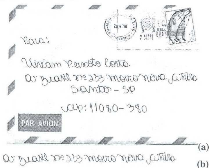
Figura 4.3: Exemplo de segmentação Figura-Fundo: a) imagem original, b) “bloco-endereço manuscrito” com o campo endereço=nome de rua+ bairro segmentado.
