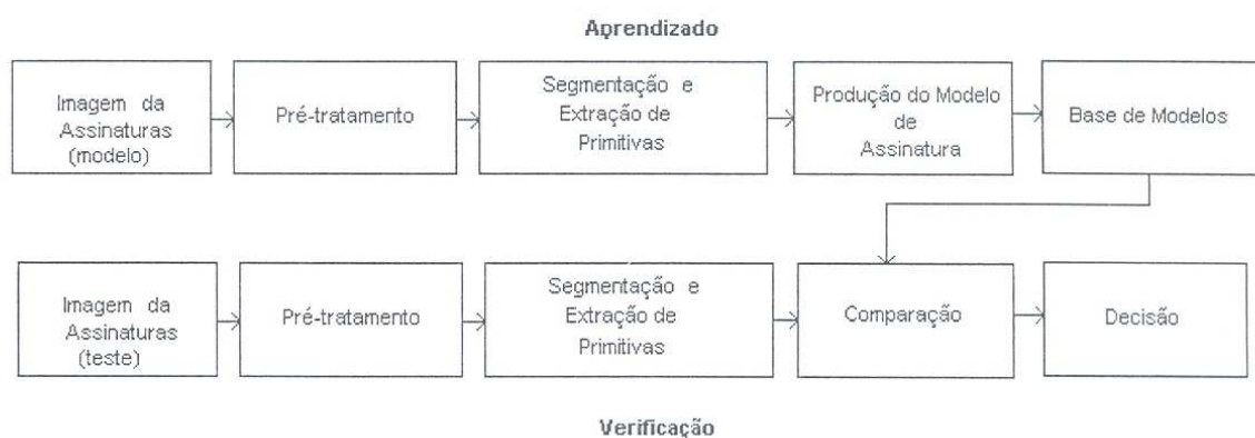
Figura 4.12. Componentes de um sistema de verificação automática de assinaturas manuscritas.
