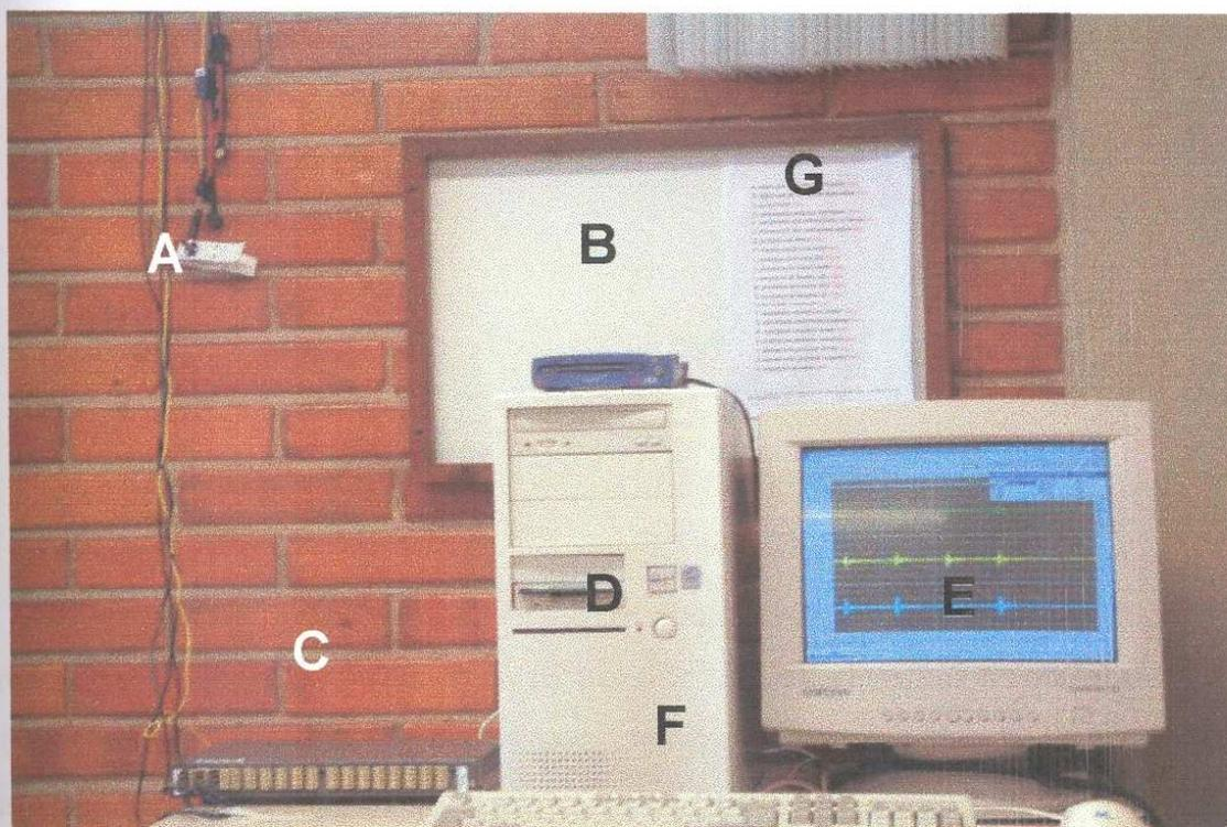
LEGENDA: (A) Cabos para a condução do sinal ao eletromiógrafo; (B) unidade removível para armazenamento dos dados; (C) eletromiógrafo; (D) microcomputador com placa de conversão A/D instalada; (E) tela do monitor; (F) teclado do computador; (G) painel com a seqüência das avaliações eletromiográficas.
