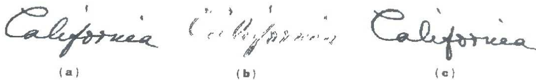
Figura 15 : Correção da inclinação: (a) imagem da palavra de entrada, (b) pixels das bordas verticais e próximas a verticais, (c) imagem da palavra após a correção da inclinação [Shridhar97]
