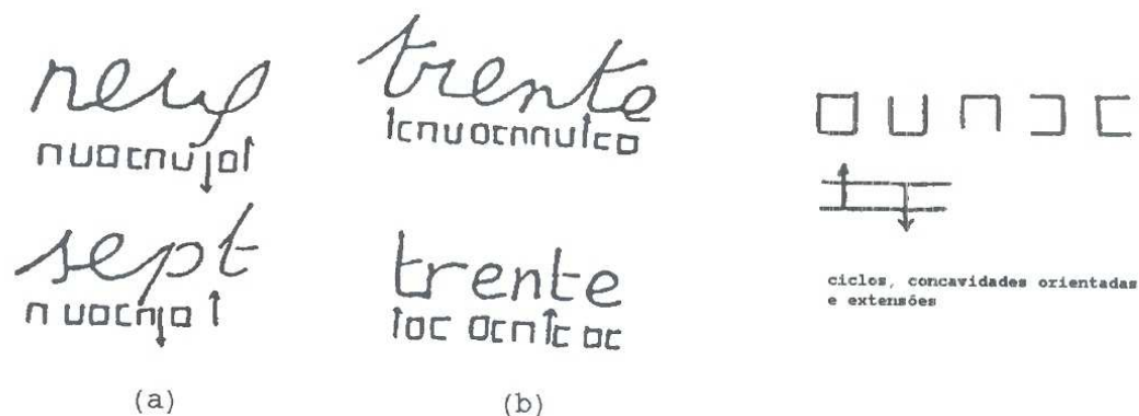
Figura 24 : Extração de características por técnicas globais. (a) palavras diferentes com representações semelhantes e (b) mesma palavra com representações diferentes [Lecolinet91]
