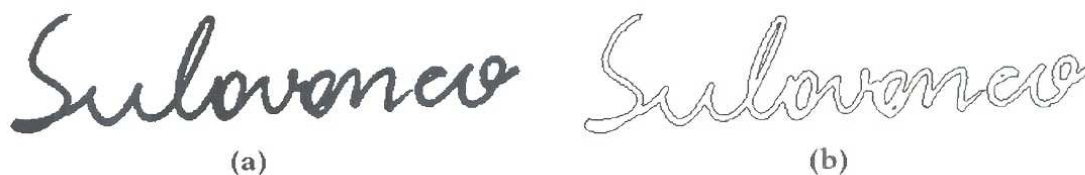
Figura 13 : Contornos pela seqüência da informação (Chain Code). (a) Imagem original e (b) contorno da palavra
