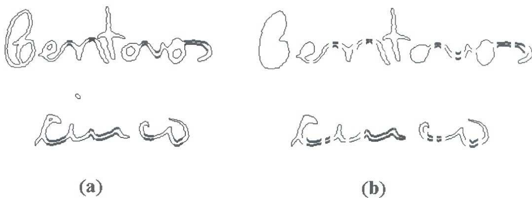
Figura 58 : Quebra da ligação por interseção. (a) Detecção das ligações. (b) Quebra das ligações com interseção.
