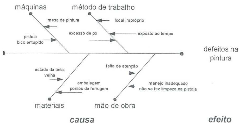
Figura 17 - Exemplo de Aplicação do Diagrama de Causa e Efeito.
