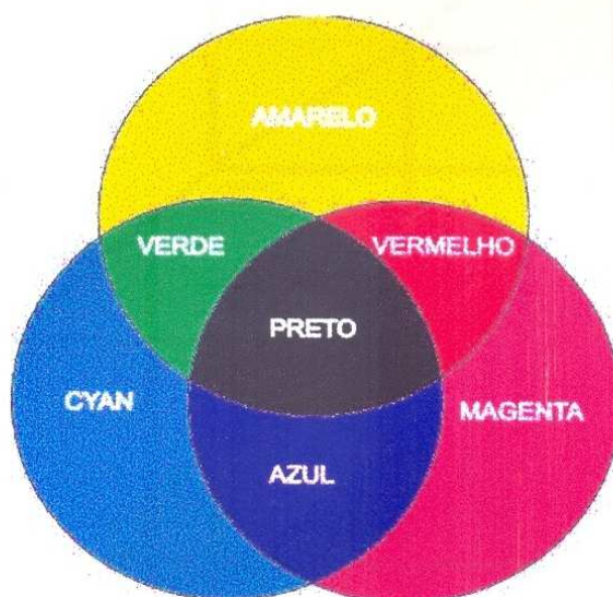
Figura 3.4: Sistema subtrativo de cores ou CMY .
