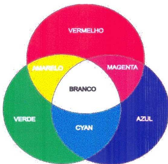
Figura 3.3: Sistema aditivo de cores ou RGB .
