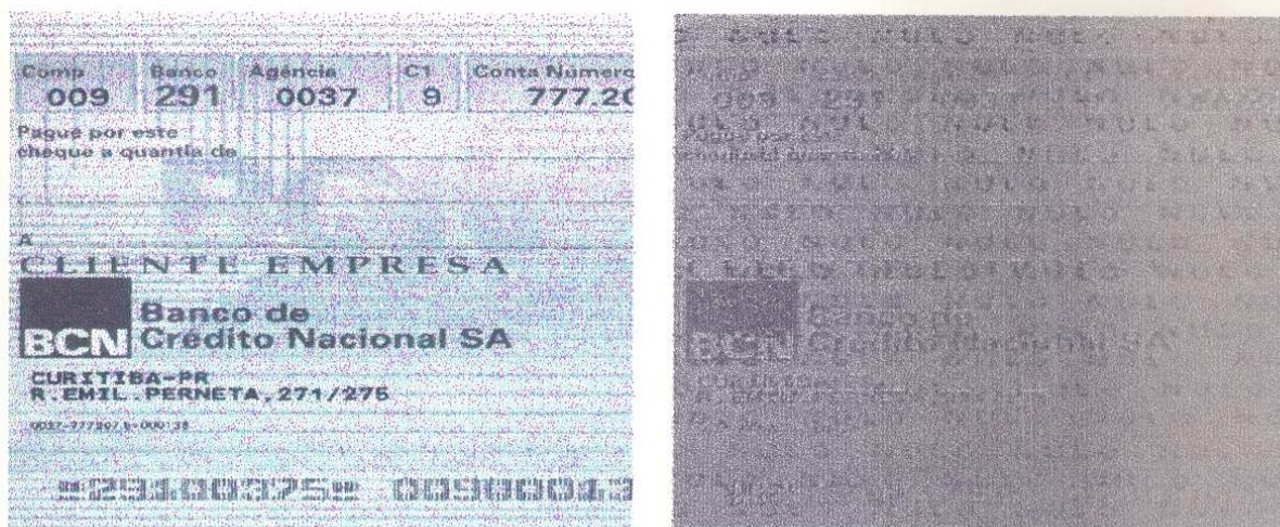
Figura 2.12: Impressão de segurança em ultravioleta vista sob o canal de matiz
