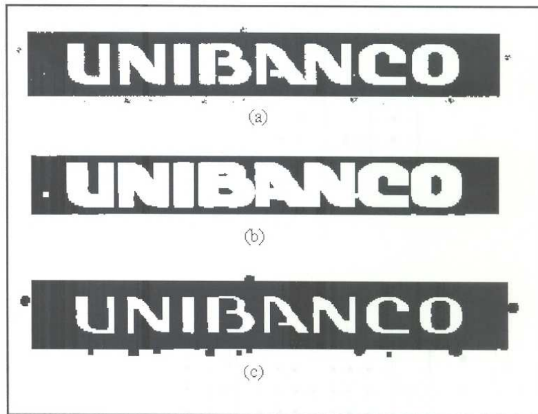
Figura 4.4 Resultado da erosão e da dilatação com elemento estruturante quadrado e 2 iterações. (a) imagem original; (b) imagem erodida; (c) imagem dilatada.
