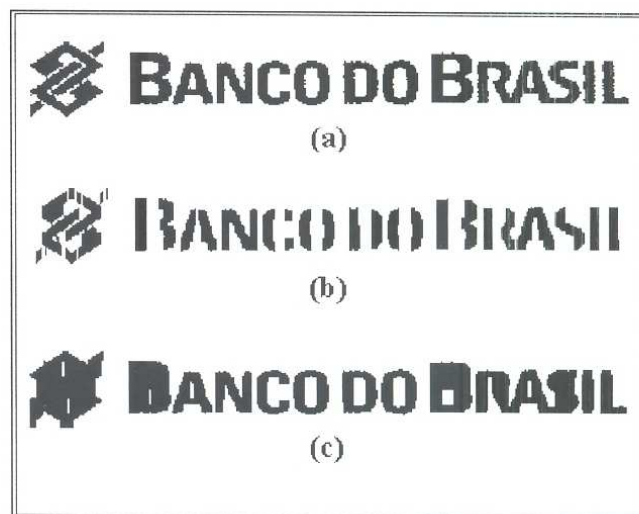
Figura 4.5 Resultado da abertura e do fechamento com elemento estruturante vertical e 4 iterações. (a) imagem original; (b) abertura; (c) fechamento.
