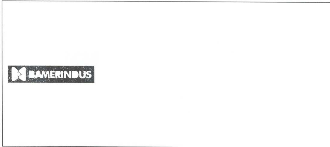
Figura 5.30 Porção isolada do logotipo obtida na i -ésima classe gerada pelo processo granulométrico, aplicado em uma imagem de cheque em branco.
