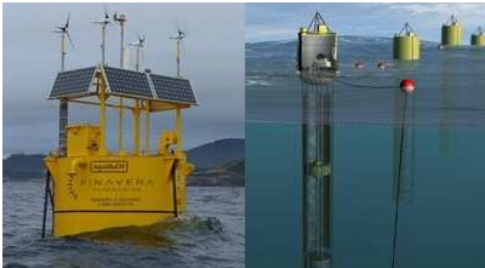
Figura 1.6: Usina de energia das ondas tipo “absorvedor pontual”.
