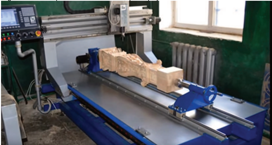
Figura 4.57 – Máquina fresadora 3D esculpindo peça ornamental em madeira.
