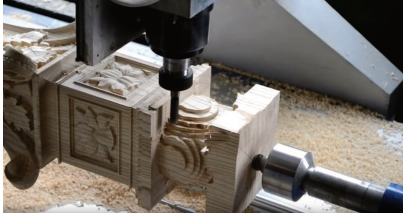
Figura 4.58 – Máquina fresadora 3D esculpindo peça ornamental em madeira.
