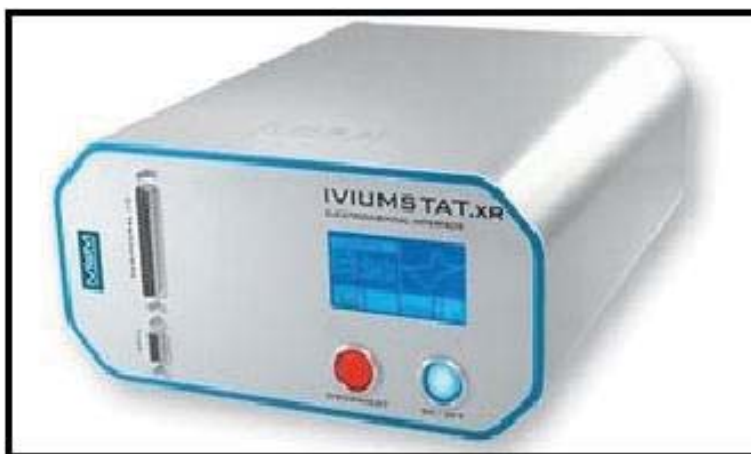
4 Figura 4. Potenciostato. (IviumStat, Ivium Technologies B. V. Eindhoven, Holanda)
