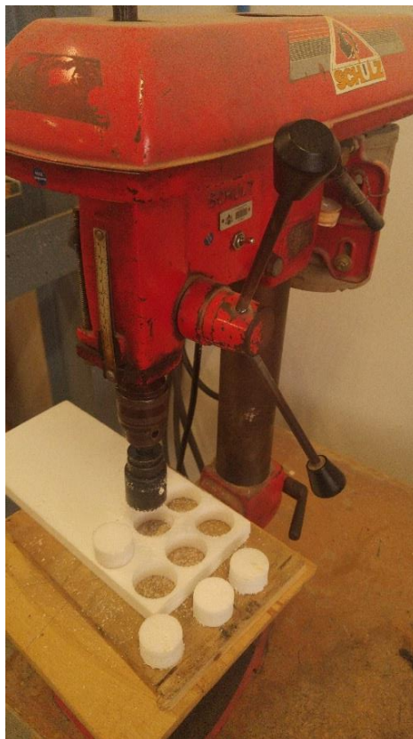
Confecção suporte no poliestireno com a serra copo no laboratório da PUCPR
