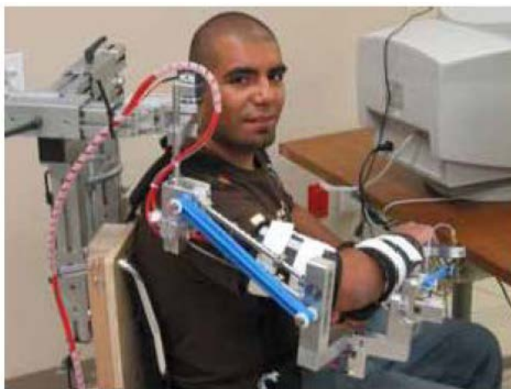
Figura 13. Órtese de Housman et al. 2007. A órtese fornece suporte graduáveis para o braço contra a gravidade usando elásticos.
