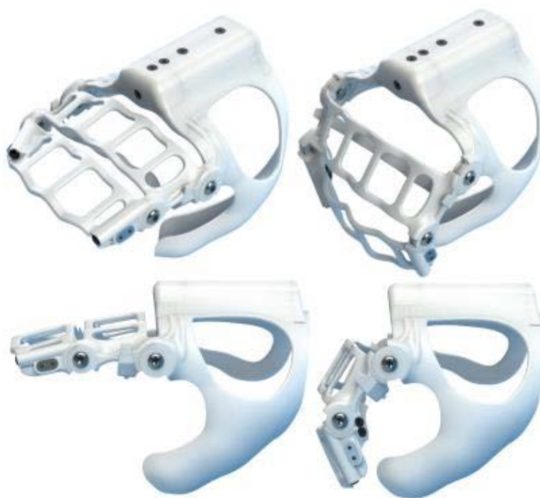
Figura 5. Protótipo de órtese de Gasser. et al. , 2015. Todos os movimentos dos dedos são feitos em conjunto por dois motores DC.
