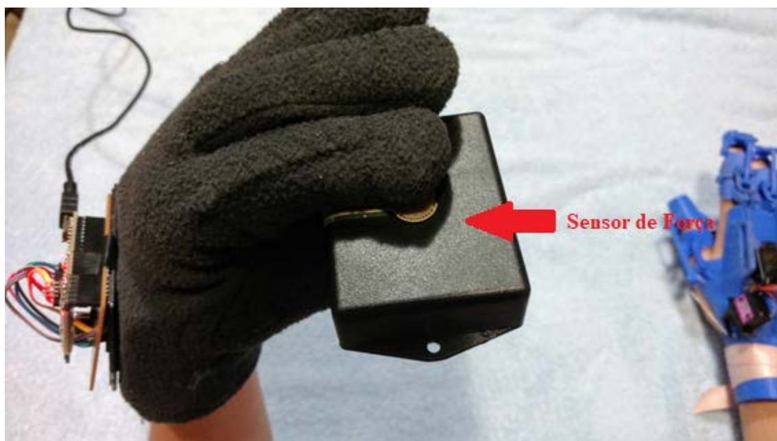
Figura 52. Vista superior dos testes com o sensor de força. Usuário utilizando a luva e pressionando a caixa para o espelhamento dos movimentos na órtese.
