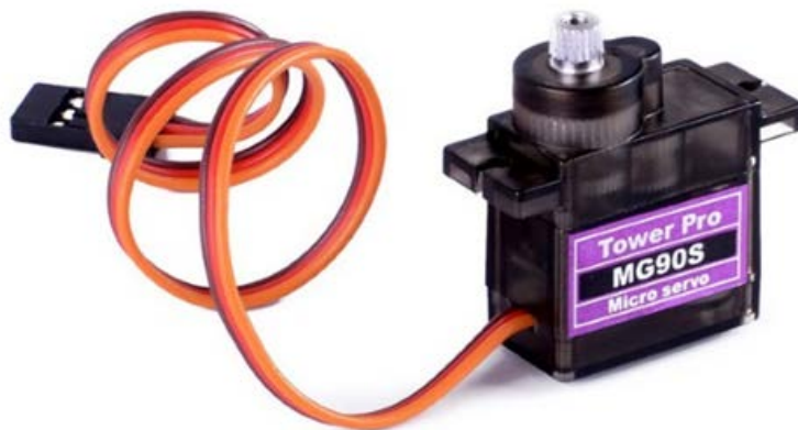
Figura 36. Servomotor MG90s. Engrenagens em metal auxiliam na segurança, uma vez que evita que ocorra patinação entre os eixos, algo comum em engrenagens de plástico.
