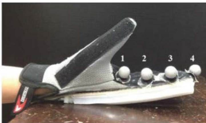
Figura 4. Órtese de Low et al. , 2015. Para o movimento da articulação metacarpofalangeana, nos segmentos 1-2 é aplicado a pressão de 1 bar, realizando o ângulo de flexão. Para a articulação interfalangeana proximal, é aplicado nos segmentos 1-2 e 2-3 e para o ângulo de flexão da articulação interfalangeana distal é aplicado nos segmentos 2-3 e 3-4.
