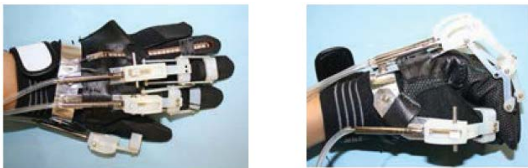
Figura 10. Órtese de Patar et al. 2014. A órtese foi testada em um indivíduo sadio para realizando o movimento de extensão (Direita) e flexão (Esquada).
