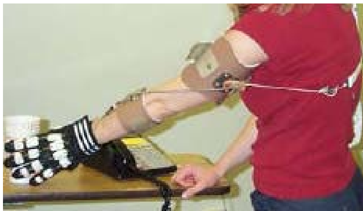
Figura 2. Órtese de Luo et al. , 2005. Órtese conectada sendo usada pelo usuário, um zíper costurado no lado da luva facilita a colocação.
