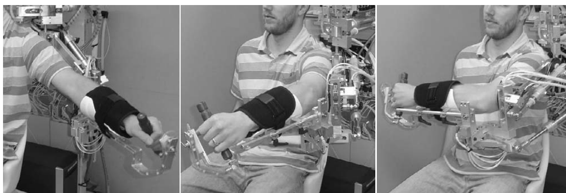
Figura 14. Órtese de Wolbrecht et al. 2006. Pneu-WREX. O dispositivo tem 4 graus-de-liberdade correspondente a rotação para frente/trás da clavícula, ombro flexão/extensão e abdução/adução horizontal e flexão/extensão do cotovelo. Dentro destes graus-de-liberdade.
