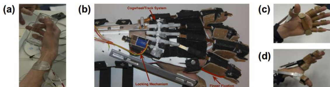
Figura 9. Órtese de Leeb et al. 2010. Em (a), mão com estimulação elétrica muscular, indicando que o dedo médio fornece a força mais forte (ponta do dedo branco devido à baixa perfusão de sangue), enquanto o dedo anelar não tem nenhuma contribuição de força. Em (b), imagem da órtese montada sobre a mão. Em (c), foto mostrando que a palma e as pontas dos dedos permanecem livres. (d) foto mostrando o polegar estabilizado.
