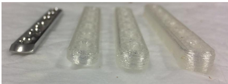
Figura 2. Apresentação das placas utilizadas durante o estudo, placa de aço cirúrgico a esquerda, a seguir as placas de PLA de 3; 4,5 e 6 mm respectivamente.
