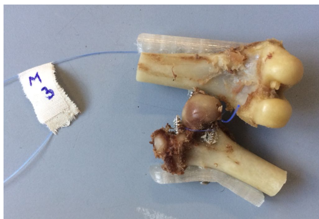
Figura 8. Deformidade plástica observada durante ensaio biomecânico em placa PLA-M (4,5mm). Nota-se ruptura completa do implante no seu centro.
