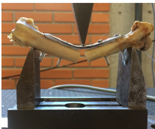
Figura 6. Deformidade plástica observada durante ensaio biomecânico com placas metálicas (Grupo Controle).
