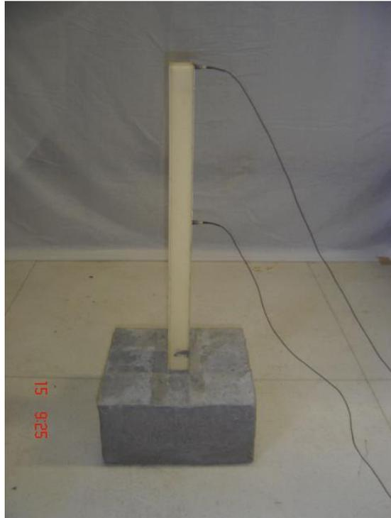
Figura 5.3 – Vista Lateral da Viga Sandwich Engastada na Base de Concreto
