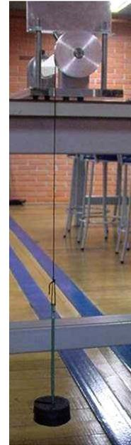
Figura 6.1 – Dispositivo Para Obtenção Experimental do Módulo de Cisalhamento (Oresten, 2003)
