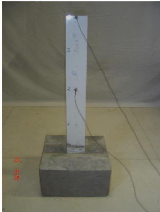
Figura 5.4 – Vista Frontal da Viga Sandwich Engastada na Base de Concreto
