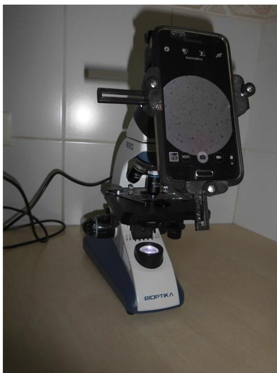
**Fig. 1.** Microscópio de luz de LED com adaptador universal para smartphone, smartphone no suporte, acoplado à lente ocular.
