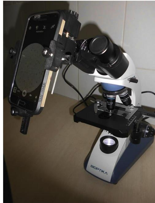
**Fig. 1.** (A) Microscópio de luz de LED com adaptador universal para smartphones acoplado à ocular. (B) Celular posicionado no adaptador para obtenção de vídeos.
