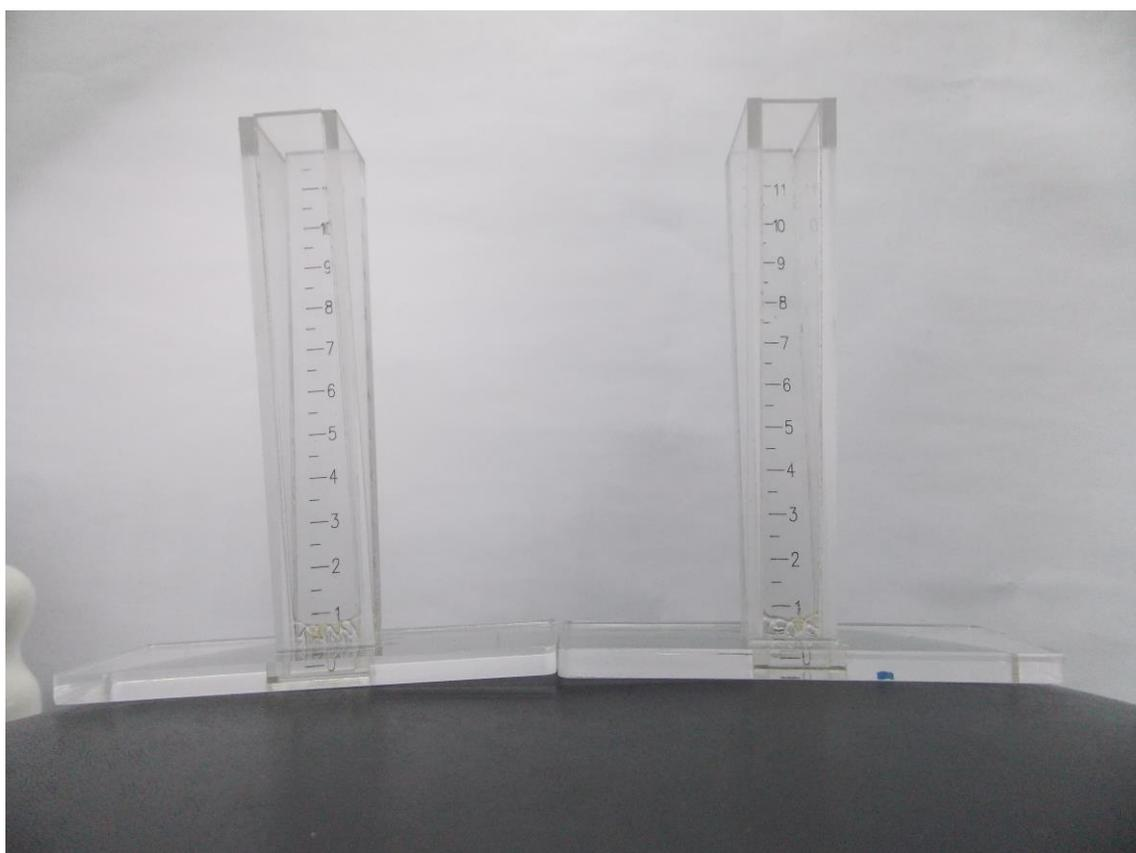
**Fig. 1.** Modelos vazios de espermiométrico de 8º e 10º respectivamente.
