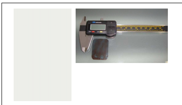
Fig 2. Medidas realizadas com o paquímetro digital eletrônico sobre a película de raio-x.
