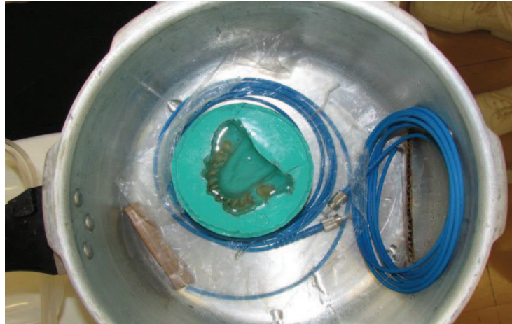
1 2 Fig. 5 Molde vazado com a resina elastomérica na panela de 3 pressão para evitar bolhas e acelerar a presa do material. 4
