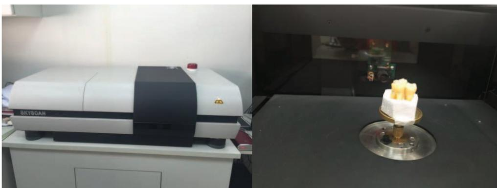
Figura 9. Micro-tomógrafo utilizado para escaneamento pré e pós-operatórios dos espécimes.
