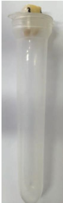
Figura 7- Tubo de Eppendorf com o espécime montado preparado para a instrumentação.
