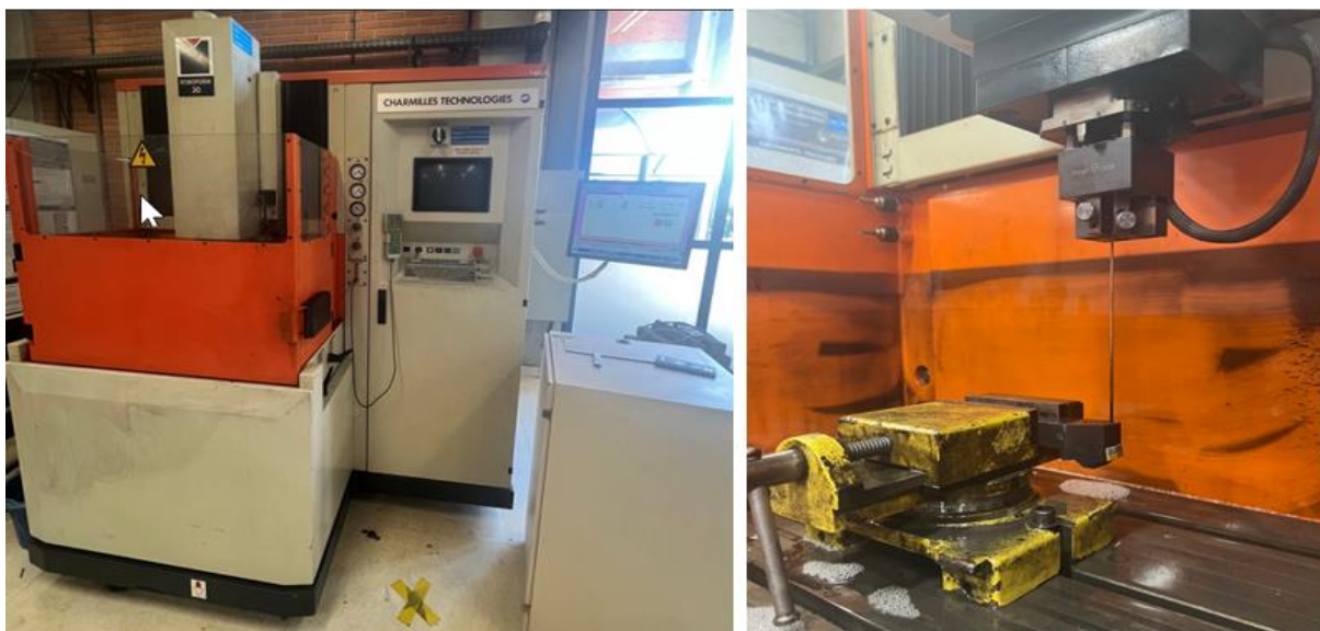
Figura 3.17 - Retrabalho dos suportes e insertos na Eletroerosão Charmilles
