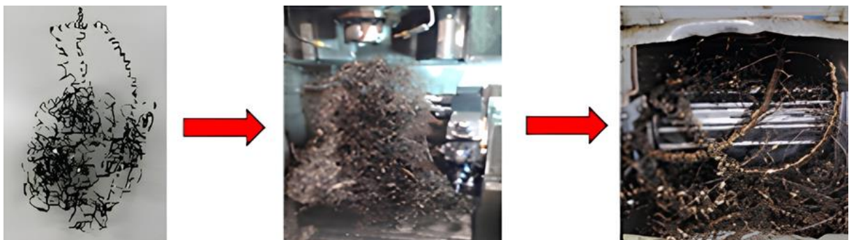
Figura 1.2 - Caso real de ninhos de cavacos formados no torneamento do aço SAE 4144 em uma multinacional
