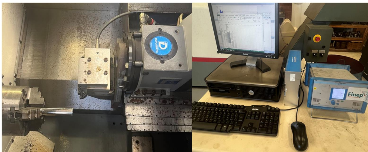
Figura 3.15 - Aquisição de dados de força e dinamômetro Kistler
