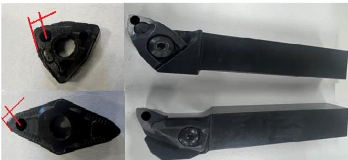
Figura 3.18 - Suportes e insertos após retrabalho para inserção dos termopares
