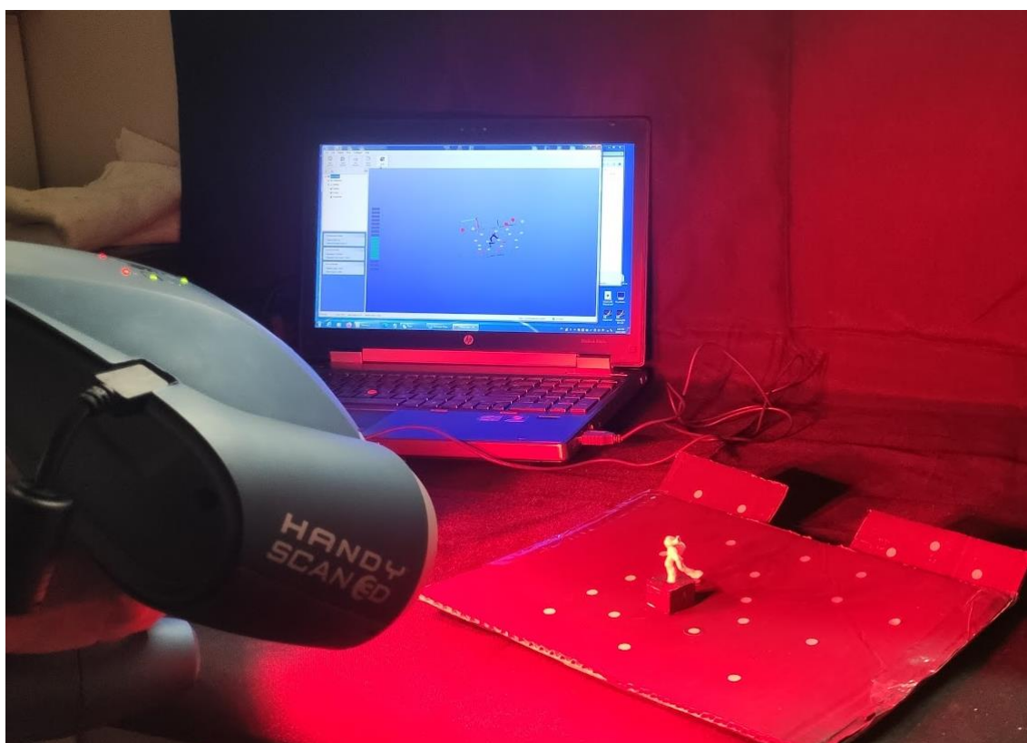
Figura 21: Escaneamento de um dos biomodelos de silicone. A peça é fixada sobre uma superfície preta, marcada com pontos de varredura. Fonte: A autora, 2023.
