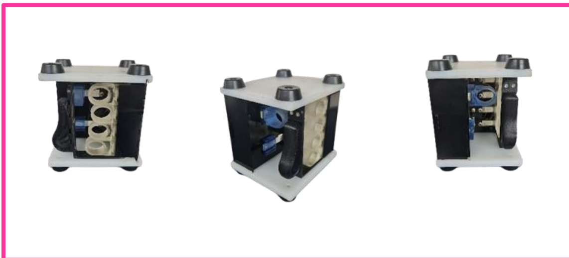
Figura 10 - DISPOSITIVO ELETROMECHANICO DE MEDIÇÃO DE FORÇA PARA PREENSÃO PALMAR (Dinamômetro Digital) Fonte: SANTOS, 2024.
