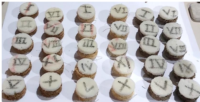
Figura 45: Amostras 28 mm de diâmetro com dupla camada de fibra natural e espuma
