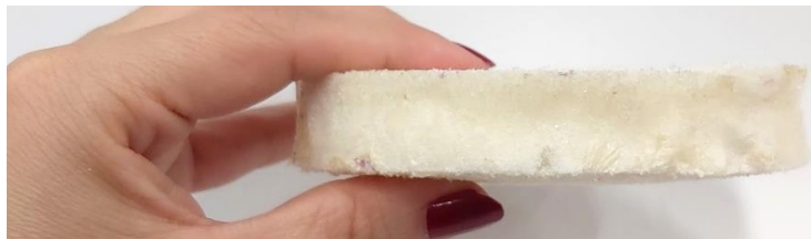
Figura 35: Amostra de espuma de Polioli de cana-de-açúcar
