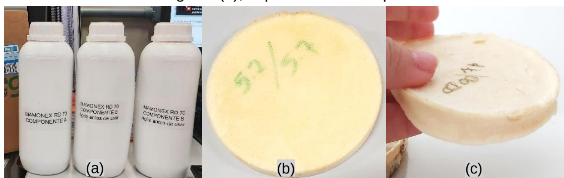
Figura 38: Componentes Isocianato_A e polioli de mamona_B (a); espuma de PUMA com mais isocianato e com maior rigidez (b); espuma com mais polioli e menos isocianato (c)
