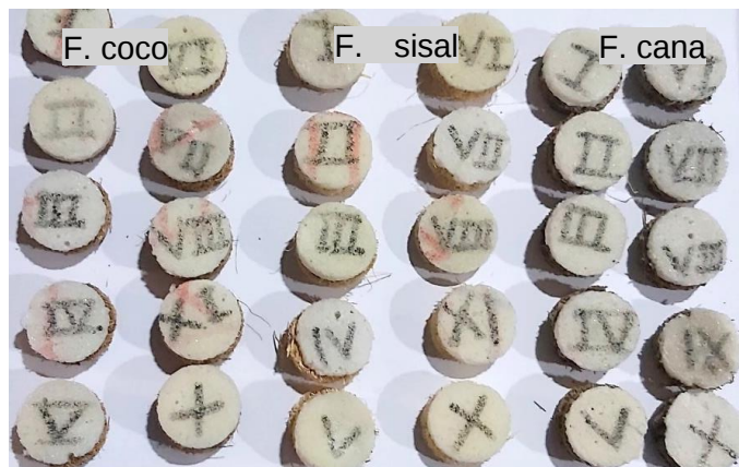
Figura 68: Amostras de Ø 28 mm com uma camada de fibra natural e outra de espuma
