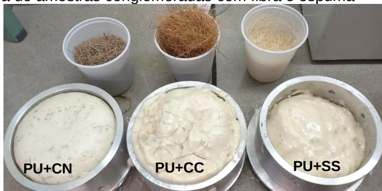
Figura 47: Técnica de amostras conglomeradas com fibra e espuma
