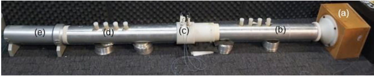
Figura 57: Bancada de resistividade ao fluxo com método de Ingard e Dier
