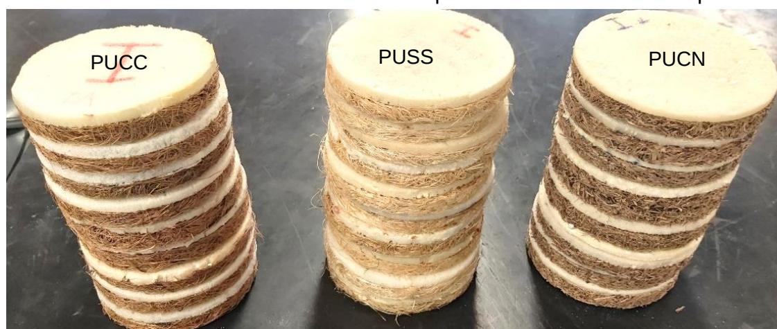
Figura 44: Amostras com camadas de fibra de espessura de 10 mm e de espuma de 5 mm
