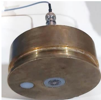
Figura 56: Terminação Rígida com entrada para 1 microfone de 1/2"
