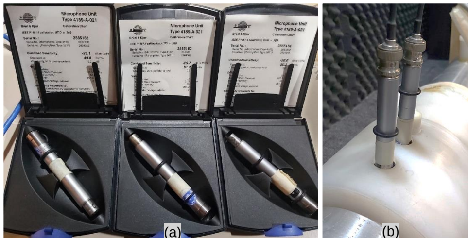
Figura 54: Em (a), os microfones da Brüel & Kjær Type 4937, 4938, 4939 pré-polarizados; em (b), dois microfones posicionados na luva do tubo de resistividade ao fluxo
