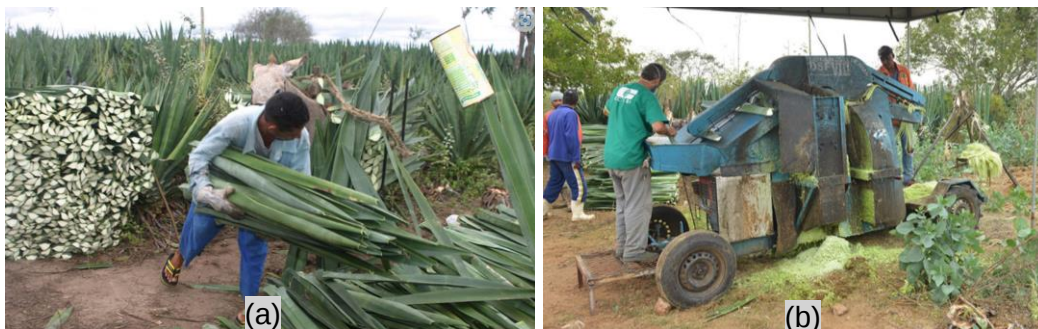
Figura 26: (a) Trabalhador colhendo sisal; (b) desfibradora para extração da fibra do sisal.
