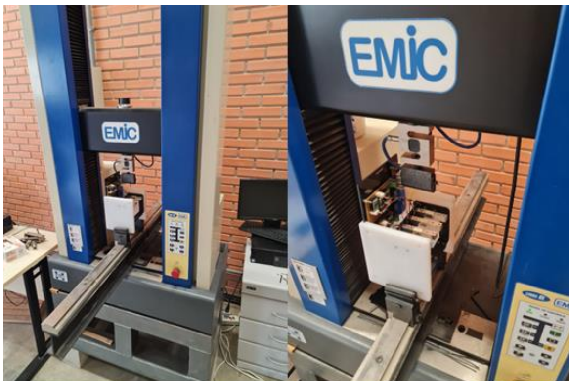
Figura 56 - Dinamômetro instalado em máquina EMIC para calibração das células de carga.
