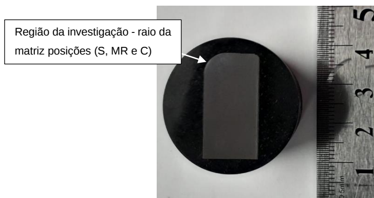
Figura 29 – Amostra embutida em baquelite para caracterização microestrutural
