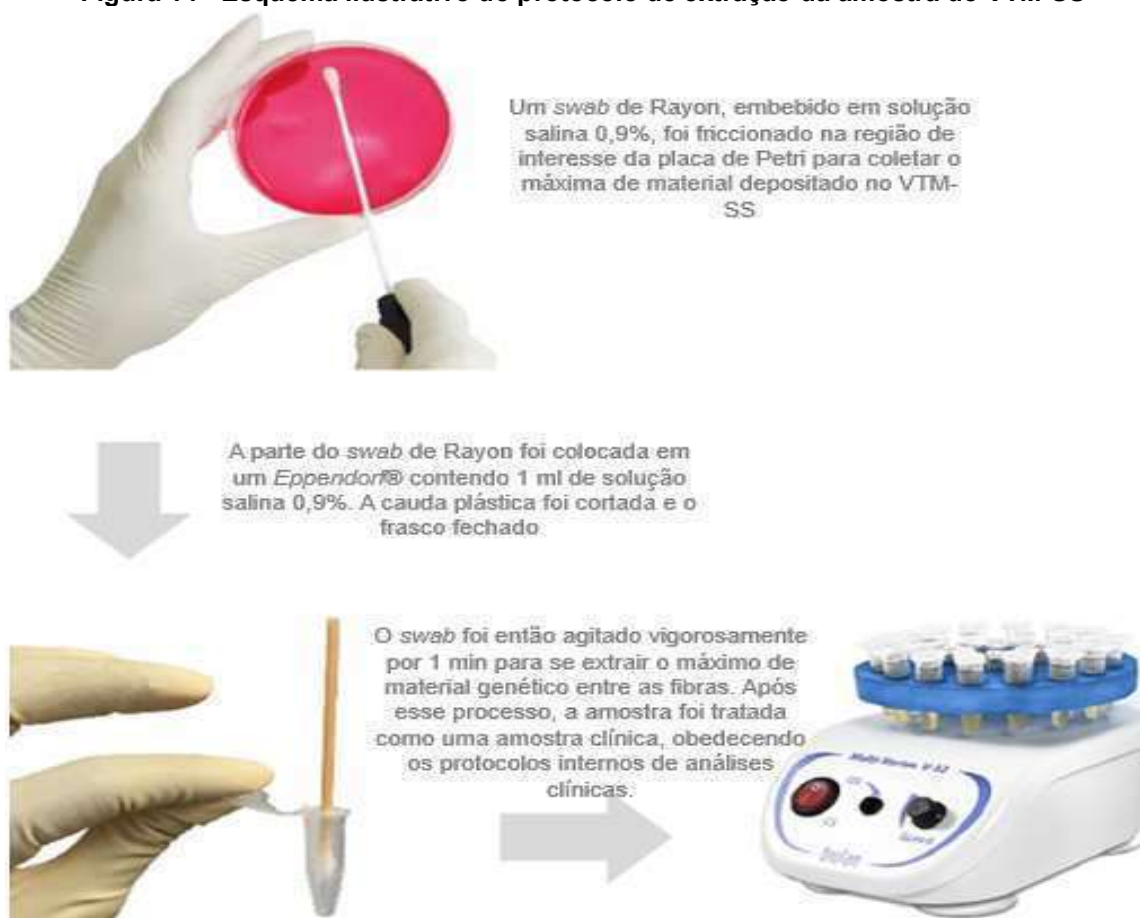
Figura 14 - Esquema ilustrativo do protocolo de extração da amostra do VTM-SS
