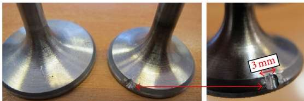
Figura 8 - Exemplo de falha mecânica na válvula de escapamento.
