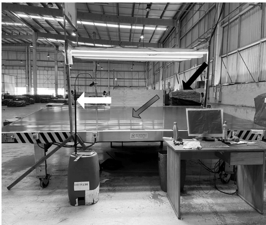
Figura 1. seta branca: suporte para máquina fotográfica, seta cinza: esteira passadora de couro, seta preta: pallets com couros
