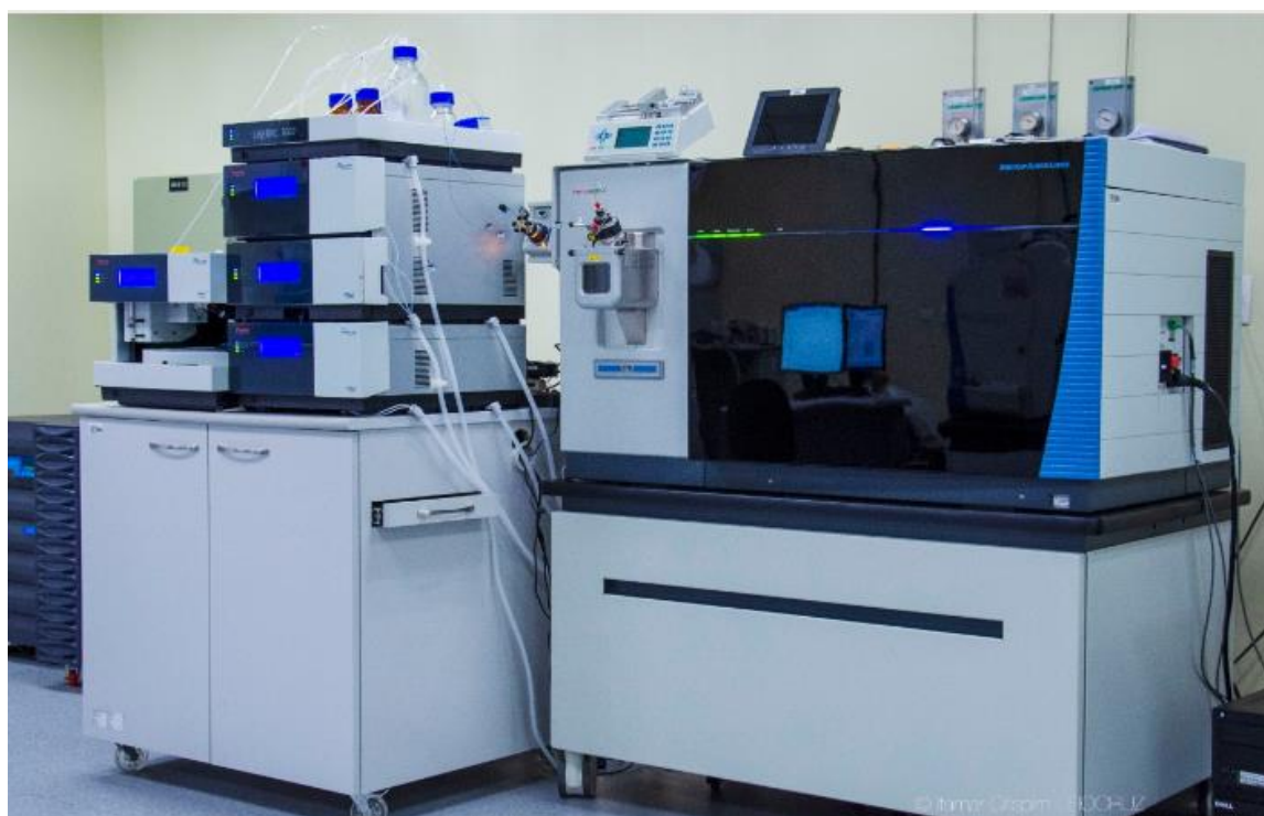
Figura 8 – Espectrômetro de massas Orbitrap Fusion™ Lumos™ (Thermo Scientific, EUA), utilizado nesse trabalho, localizado no Instituto Carlos Chagas – Fiocruz Paraná.
