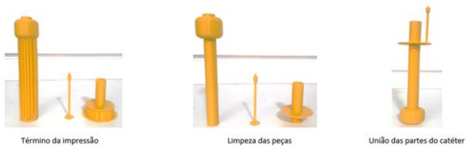
Figura 152: Término da impressão, limpeza das peças e união das partes do cateter
