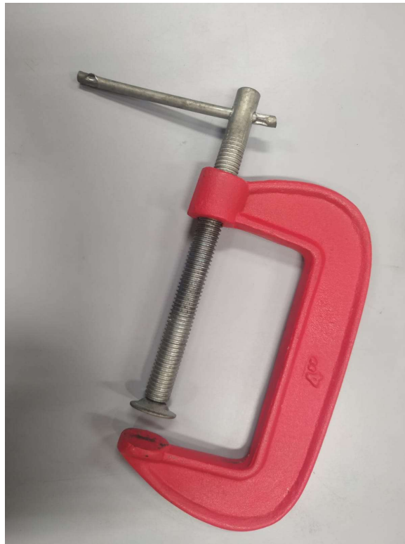
Figura 7. Grampo metálico tipo C para disposição das fibras no molde
