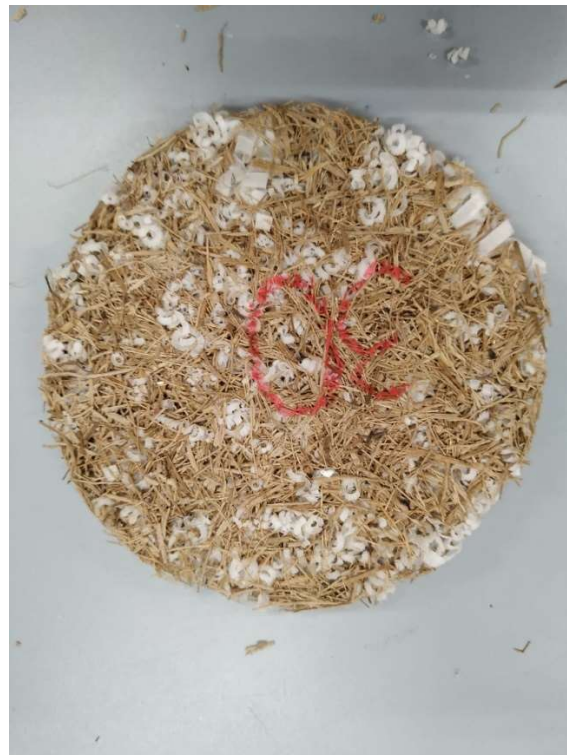
Figura 9. Amostra de Cana de açúcar com poliacetal
