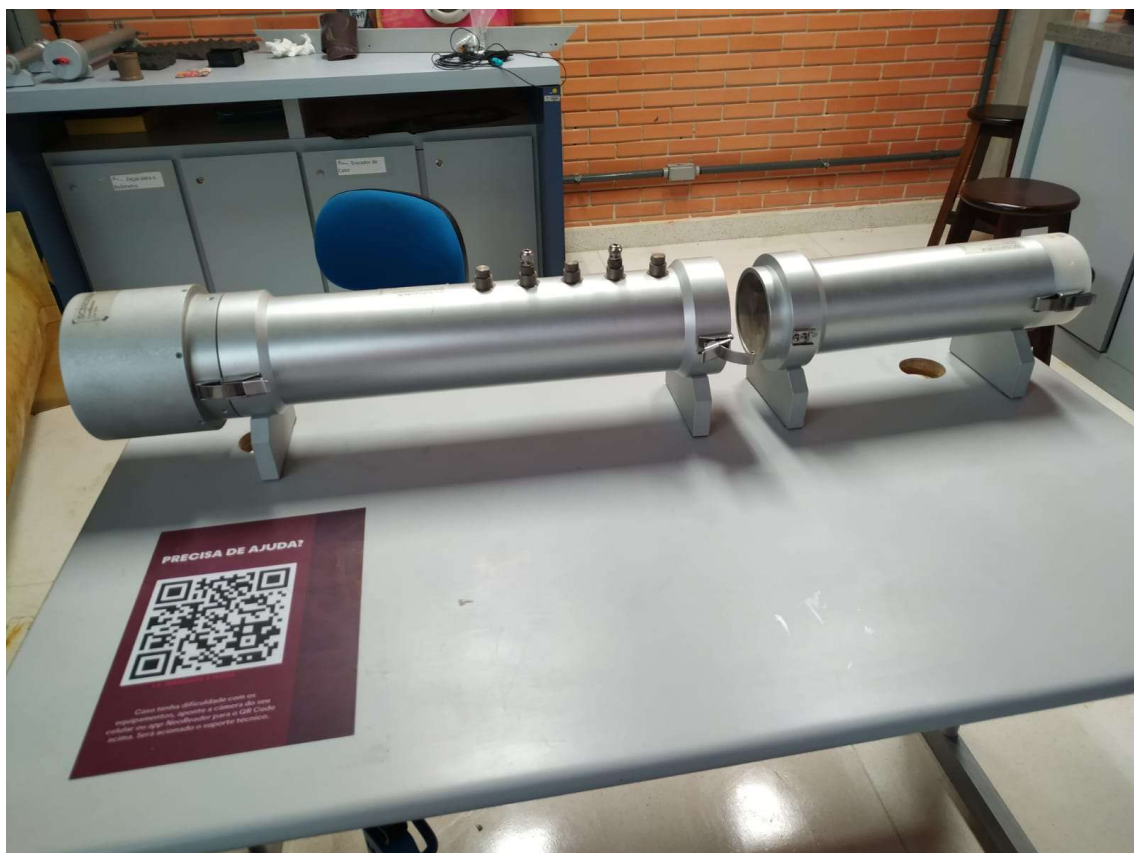
Figura 14. Tubo de impedância de 100 mm de diâmetro
