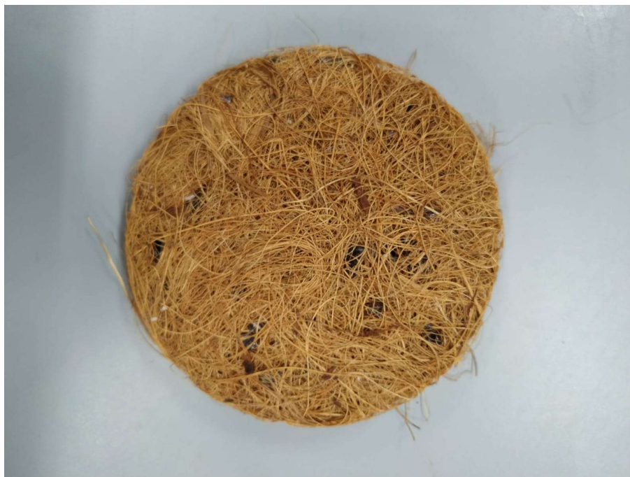
Figura 11. Amostra de coco com polisulfona
