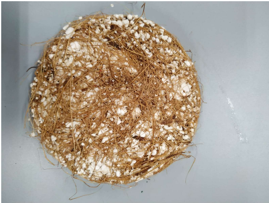
Figura 13. Amostra de coco com poliestireno
