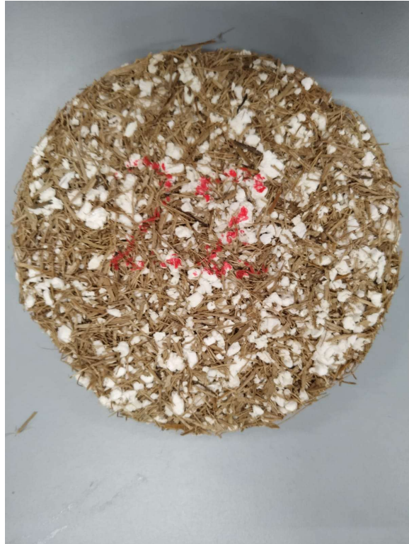
Figura 10. Amostra de Cana de açúcar com poliestireno
